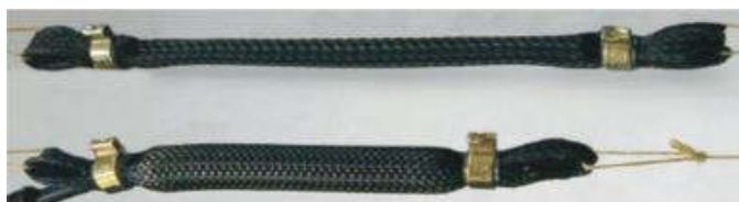
Slika 23. McKibbenov pneumatski mišić
