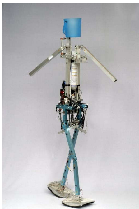
Slika 11. Pneumatski humanoidni robot Denise sveučilišta TUDelft
