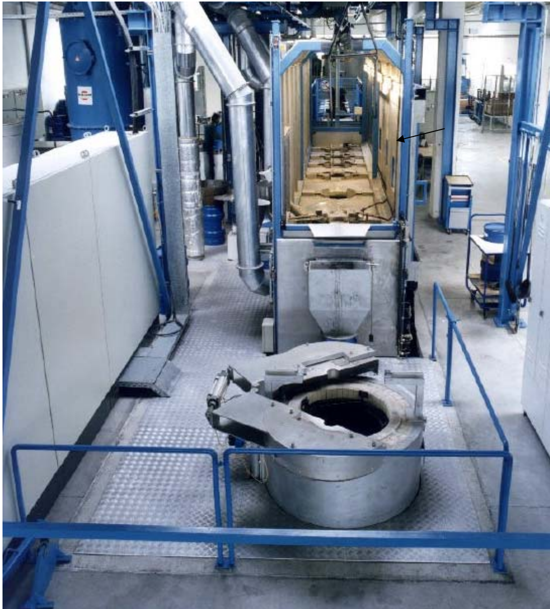
Slika 5. Automatizirano postrojenje za nitrokarburiranje s naknadnom oksidacijom u solnim kupkama (TENIFER QPQ) [ 5 ]
