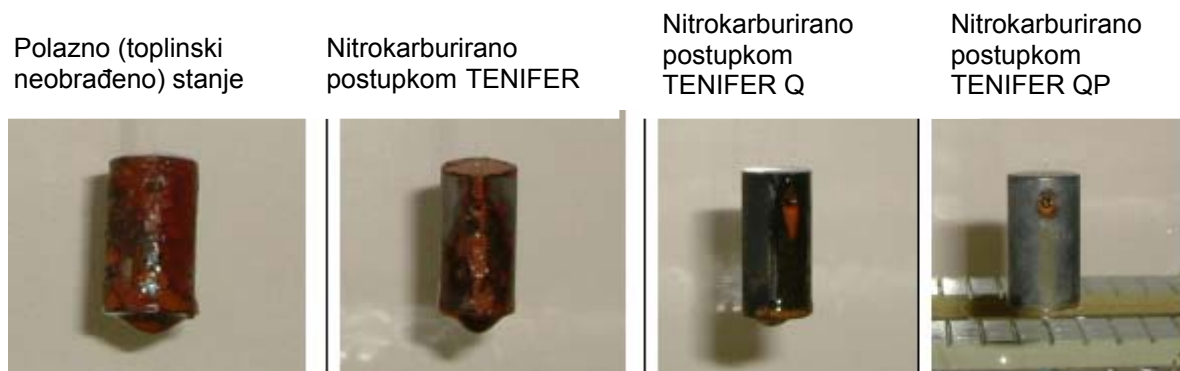
Slika 28. Fotografije korozije površine ispitnih uzoraka od čelika C45 nakon SS testa u trajanju od 96 sati [14]
