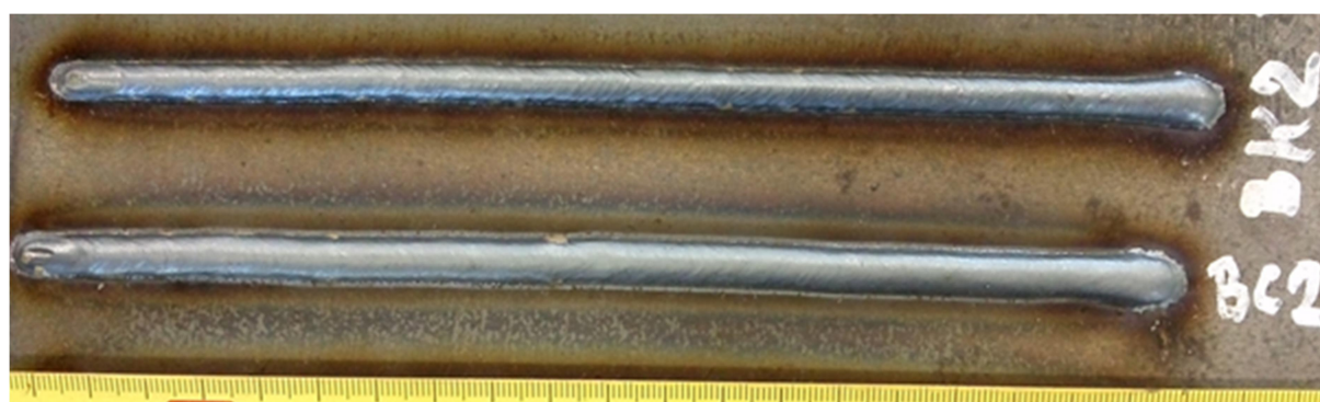
Slika 24. Izgled navara, konvencionalno i CBT (175 A, Ferroline C6 X1)
