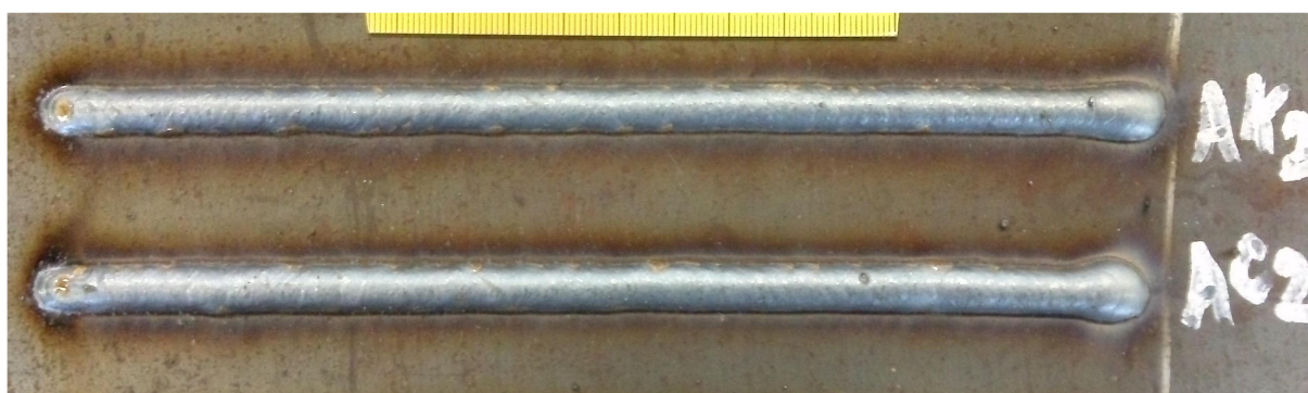
Slika 30. Izgled navara, konvencionalno i CBT (175 A, Ferroline C5 X5)
