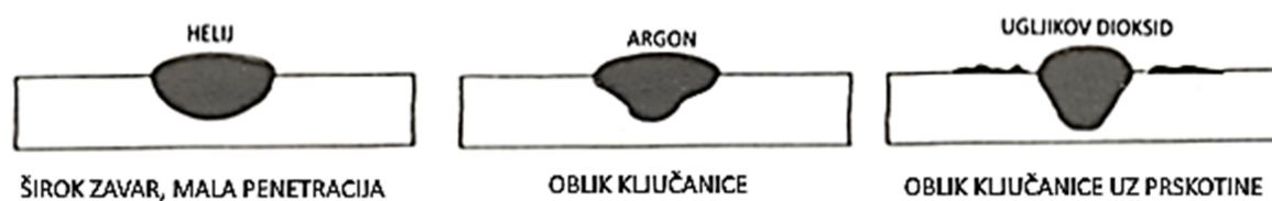
Slika 15. Utjecaj plinova na geometriju zavara [5]
