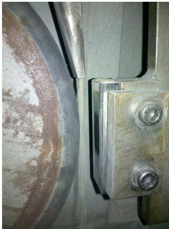
Slika 26. Detalj uređaja i trag trošenja na uzorku [1]
