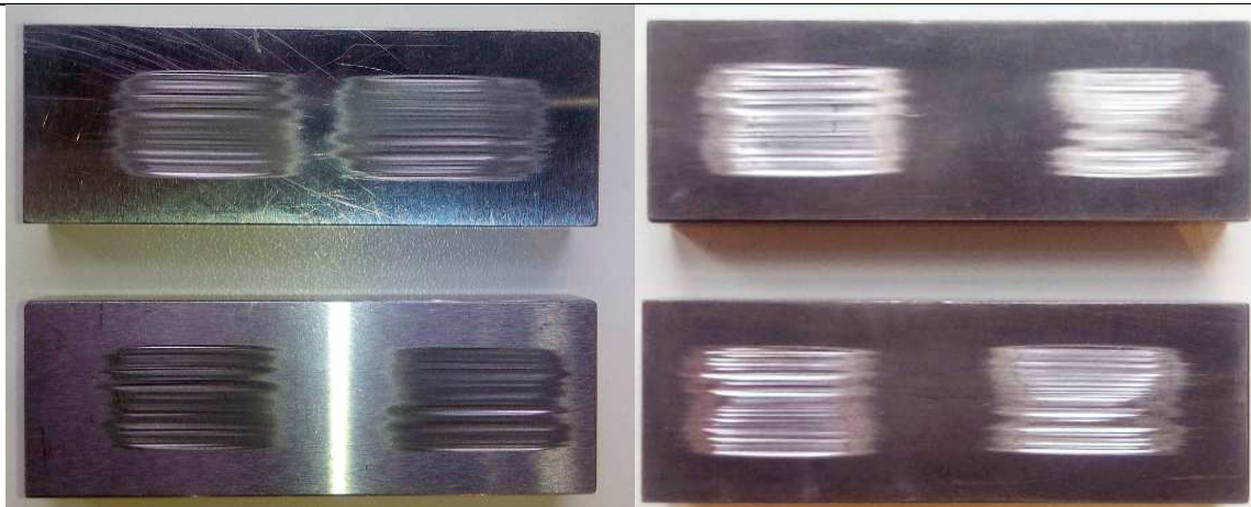
Slika 27. Ispitni uzorak nakon ispitivanja otpornosti na abraziju
