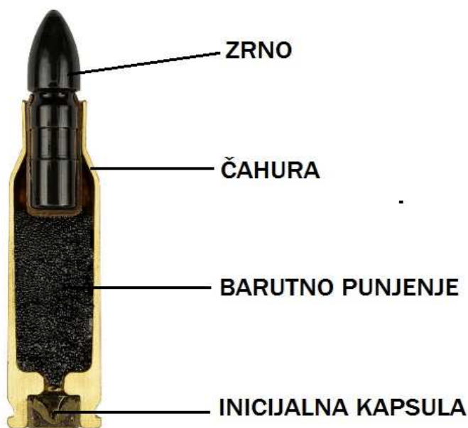
Slika 6. Poprečni presjek metka [1]
