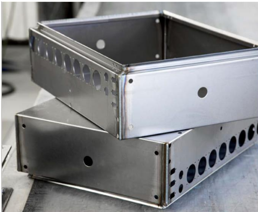
Slika 24. Metalna kutija zavarena Wisethin postupkom [17]
