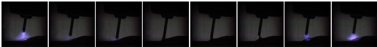
Slika 16. Slijed odvajanja kapljice kod CMT postupka [14]
