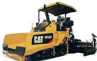
**Slika 9. Stroj za asfaltiranje**
