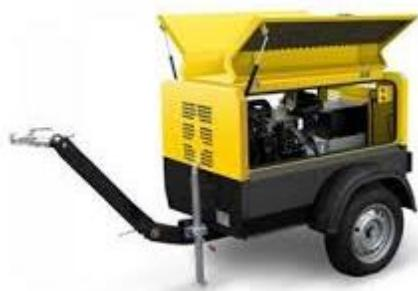
**Slika 27. Stroj za zavarivanje**
