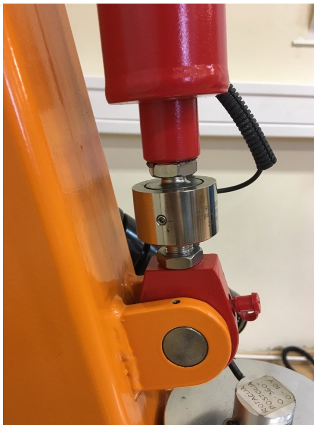
Slika 18. HBM senzor sile ugrađen na podnožju podiznog cilindra
