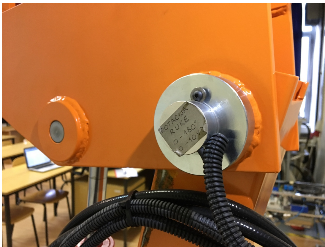
Slika 15. Rotacioni davač kuta zakreta ruke manipulatora
