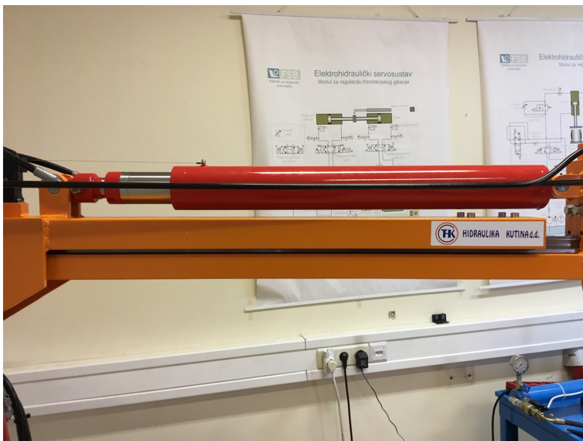
Slika 6. Teleskopski dvoradni hidraulički cilindar
