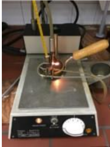
Slika 1: Uređaj Pensky-Martens Semi Automatic
