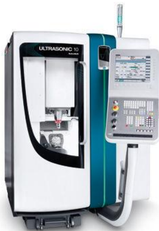
Slika 17. Hibridni ultrazvučni alatni stroj „Ultrasonic 10“ [13]
