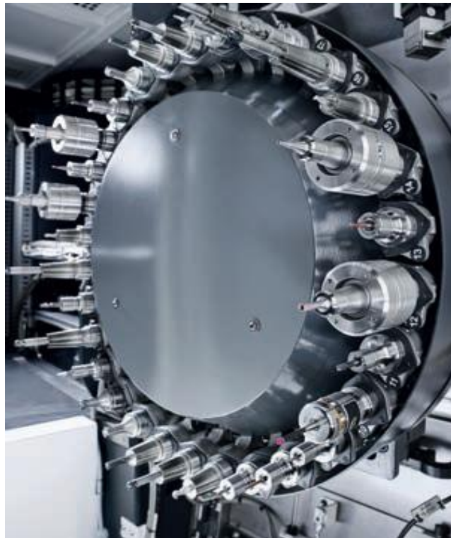
Slika 19. Izmjenjivač alata sa spremište za 30 alata [13]
