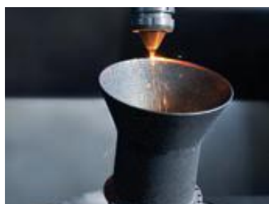
7: laserska izrada koničnog ljevka
