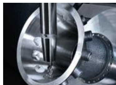
12: glodanje unutarnjih kružnih džepova
