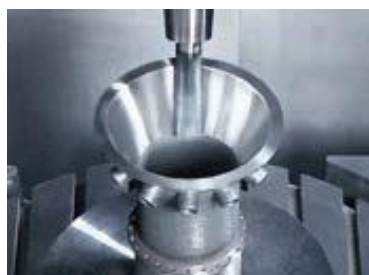
11: glodanje ruba i vanjske konture
