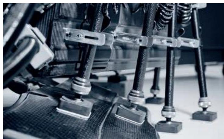
Slika 21. Vakumske nožice s kuglastim zglobovima [13]
