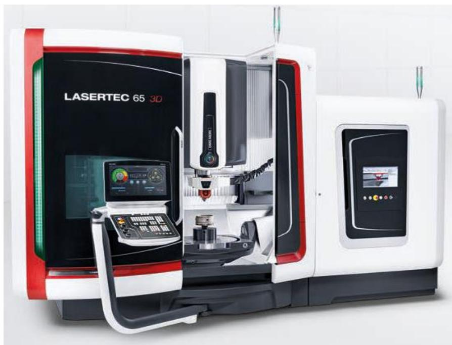
Slika 6. Hibridni alatni stroj Lasertec 65 3D [8]
