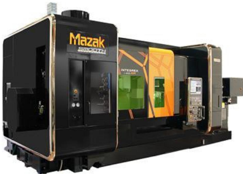
Slika 13. Hibridni višenamjenski alatni stroj Integrex i-400 AM [12]
