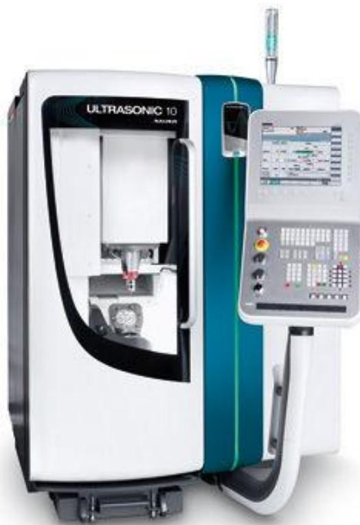
Slika 17. Hibridni ultrazvučni alatni stroj „Ultrasonic 10“ [13]
