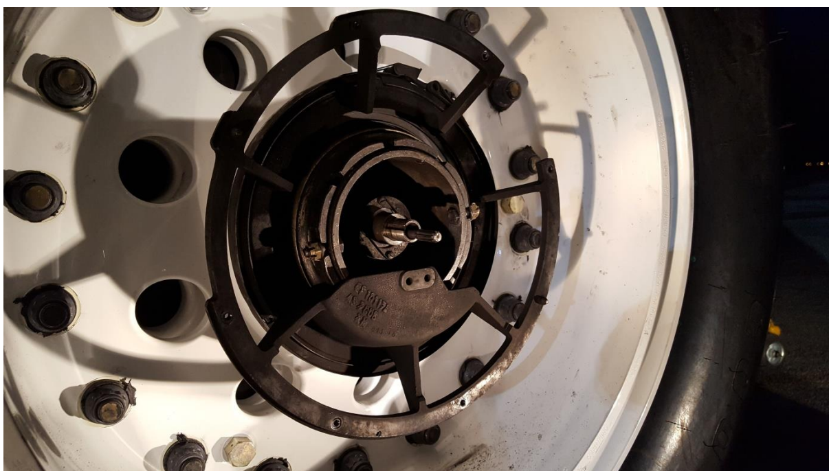
Slika 28. Skidanje nosača ventilatora
