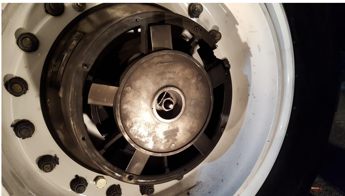
Slika 26. Skidanje ventilatora za hlađenje kočnice
