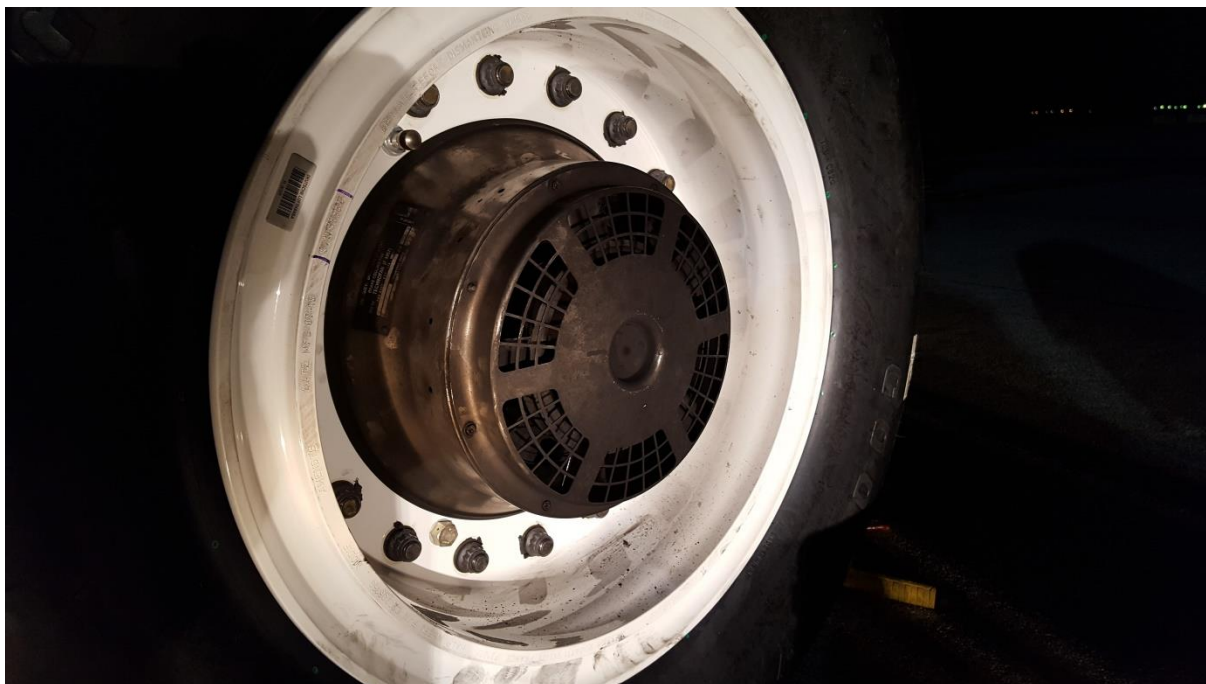
Slika 25. Skidanje zaštite ventilatora kočnice
