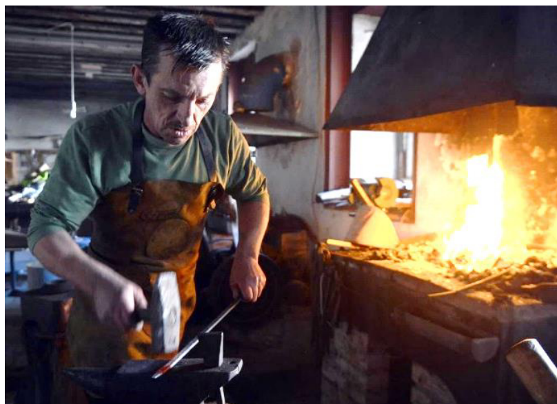
Slika 1. Kovanje snagom ruke udarcima čekića po nakovnju [1]
