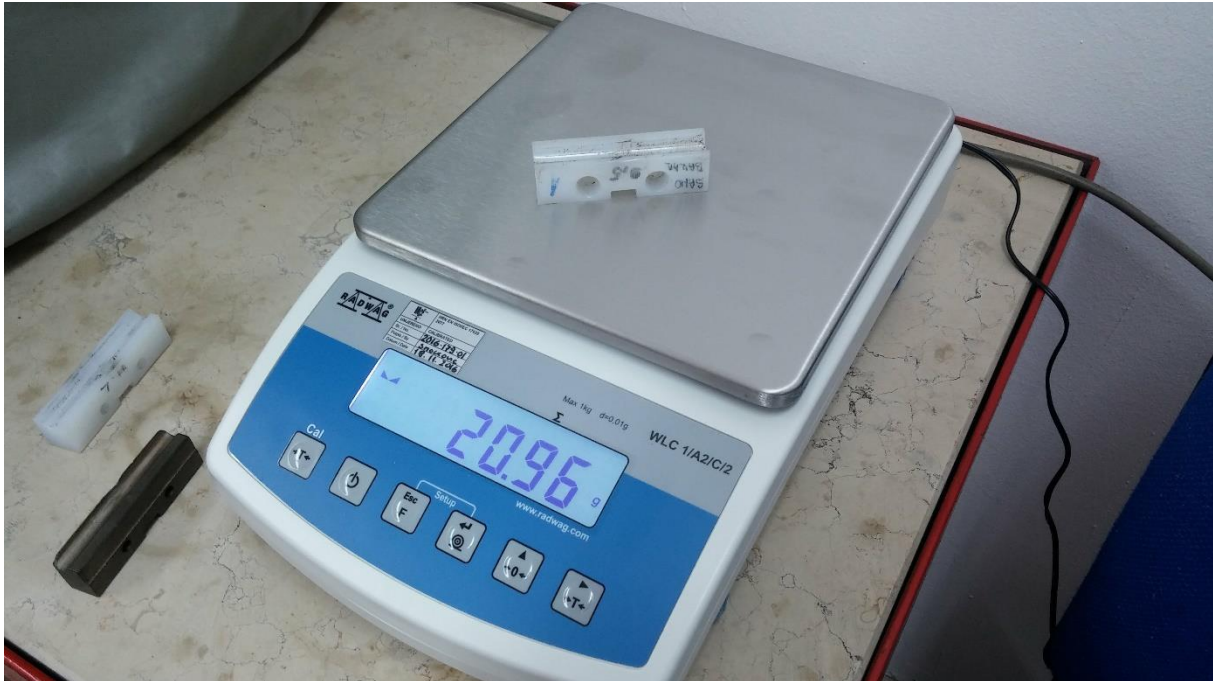
Slika 11. Vaganje neočišćenog potrošenog alata nakon eksploatacije
