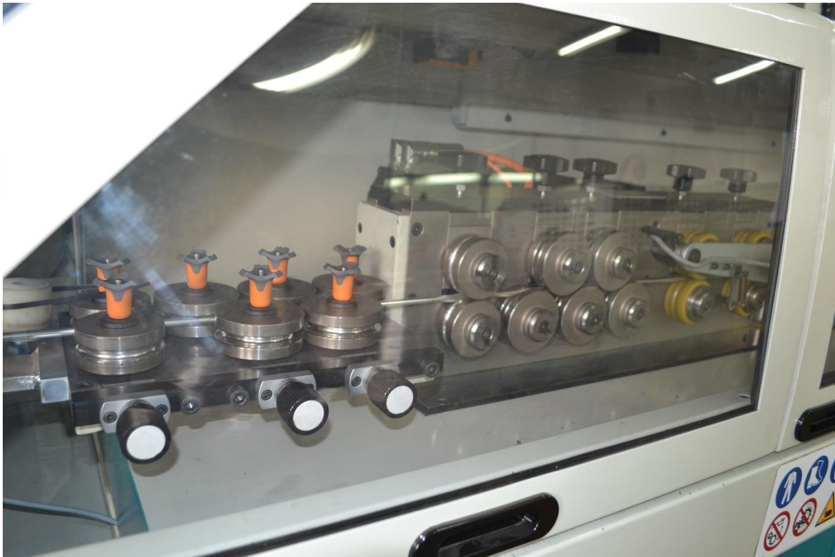
Slika 2. Sustav valjaka za vođenje cijevi
