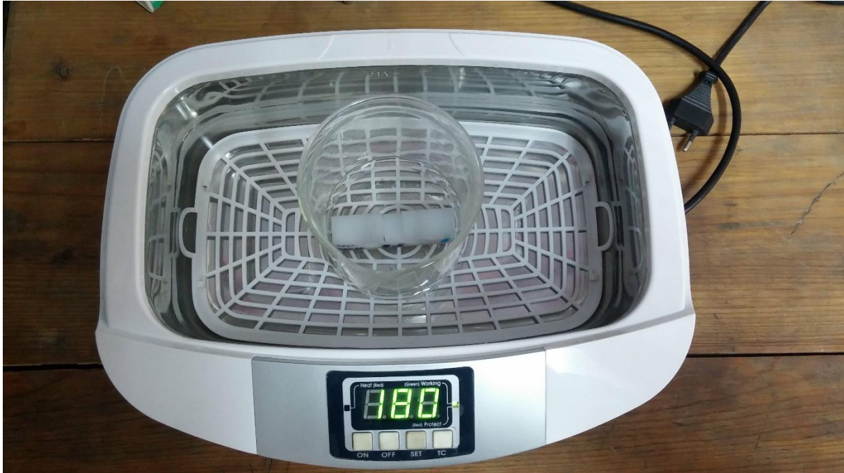
Slika 13. Ultrazvučno čišćenje polimernog alata
