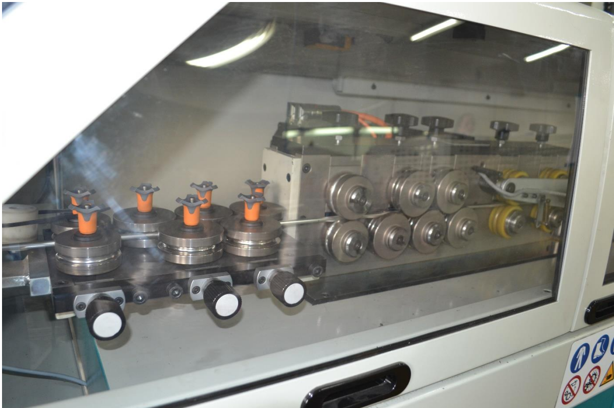
Slika 2. Sustav valjaka za vođenje cijevi
