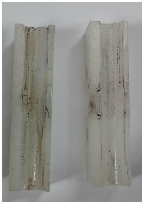
*Slika 16. Alati nakon eksploracije, s lijeva: polimerni (savijao bakar), polimerni (savijao nehrđajući čelik)*
