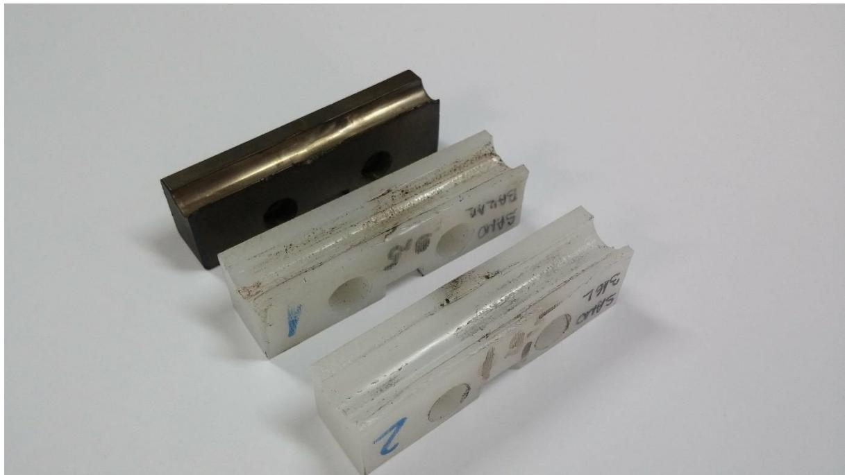
Slika 6. Alati za savijanje cijevi
