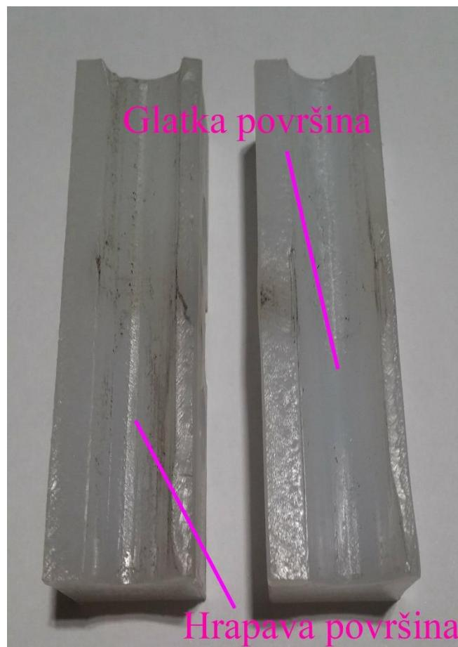
Slika 18. Dodirne površine alata (nakon čišćenja)
