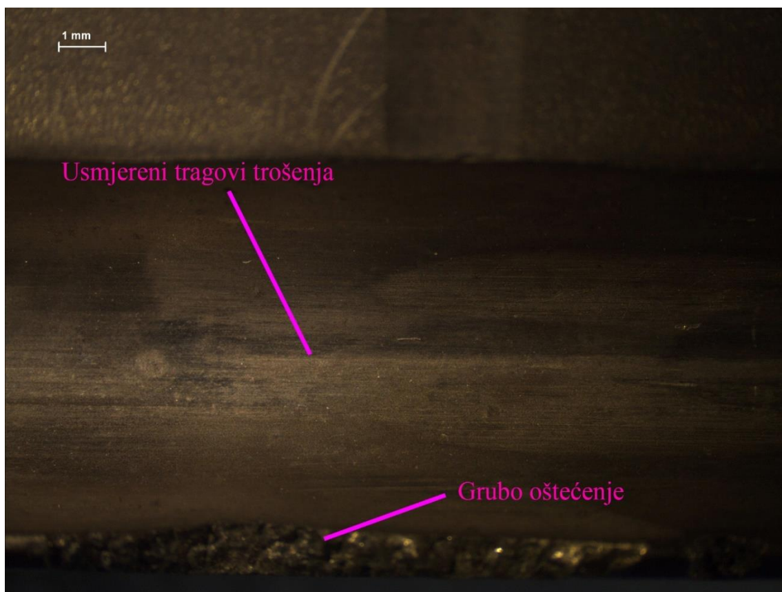
Slika 27. Tragovi trošenja brončanog alata (povećanje 7.88x)
