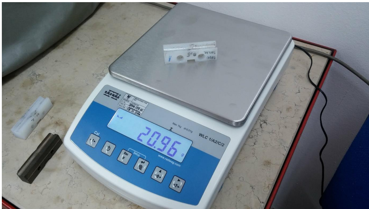
Slika 11. Vaganje neočišćenog potrošenog alata nakon eksploatacije
