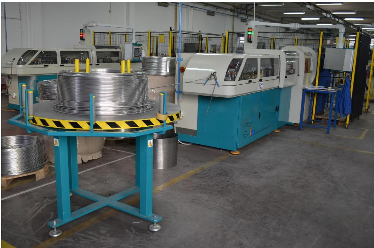
Slika 1. Prednji dio stroja za savijanje cijevi
