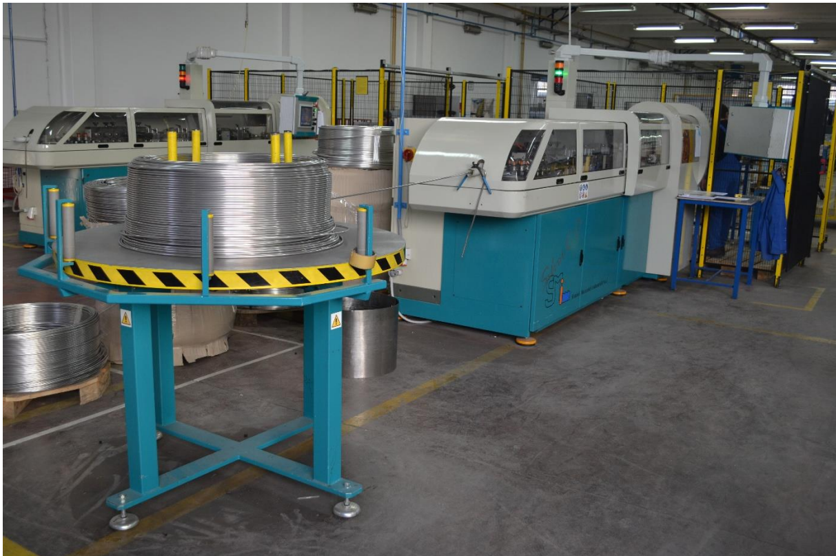
Slika 1. Prednji dio stroja za savijanje cijevi
