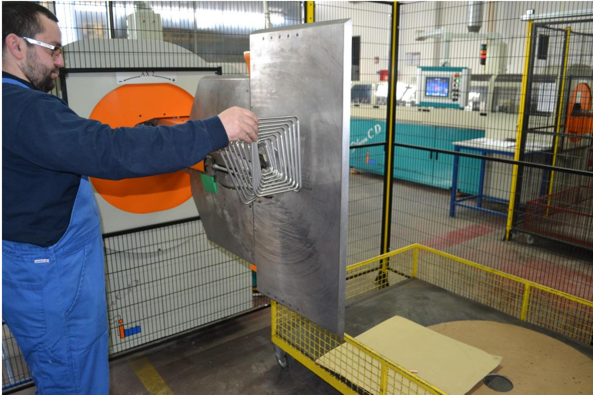
Slika 4. Zavojnica u izradi
