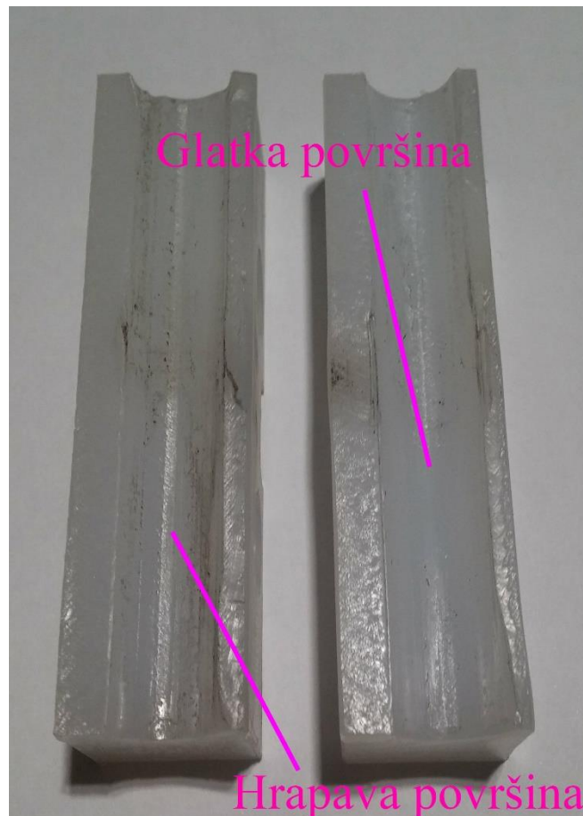
Slika 18. Dodirne površine alata (nakon čišćenja)
