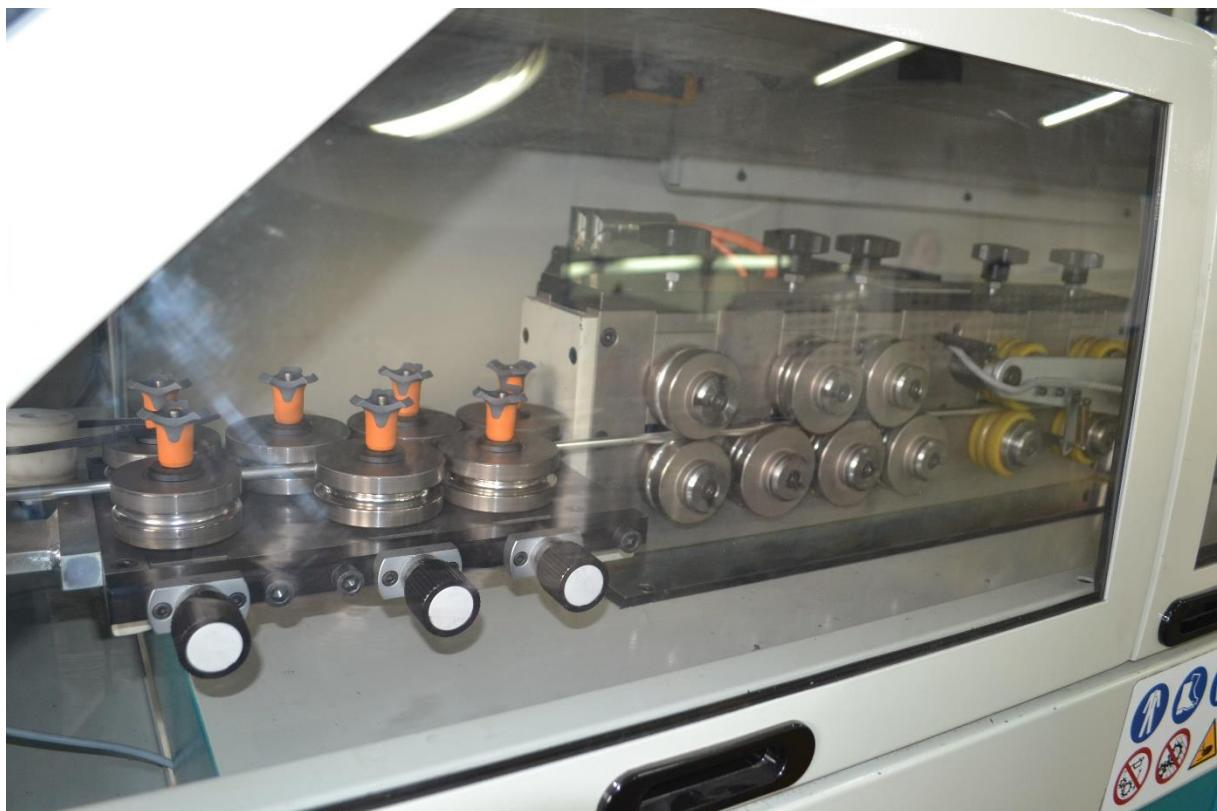
Slika 2. Sustav valjaka za vođenje cijevi
