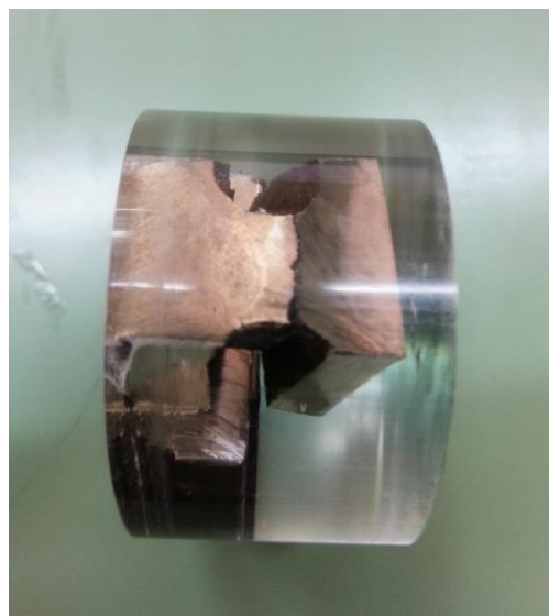
Slika 89. Napuknuće uzorka diska
