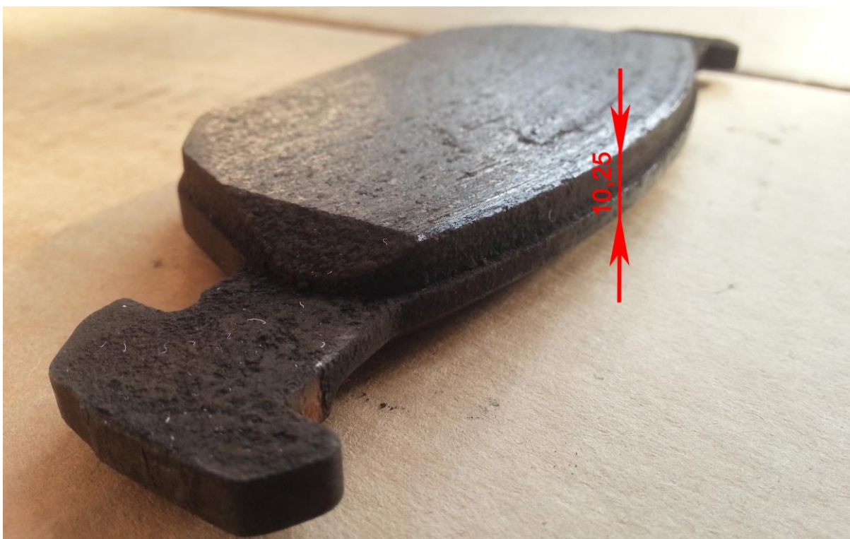
Slika 68. Debljina vanjske strane vanjske kočione pločice 1
