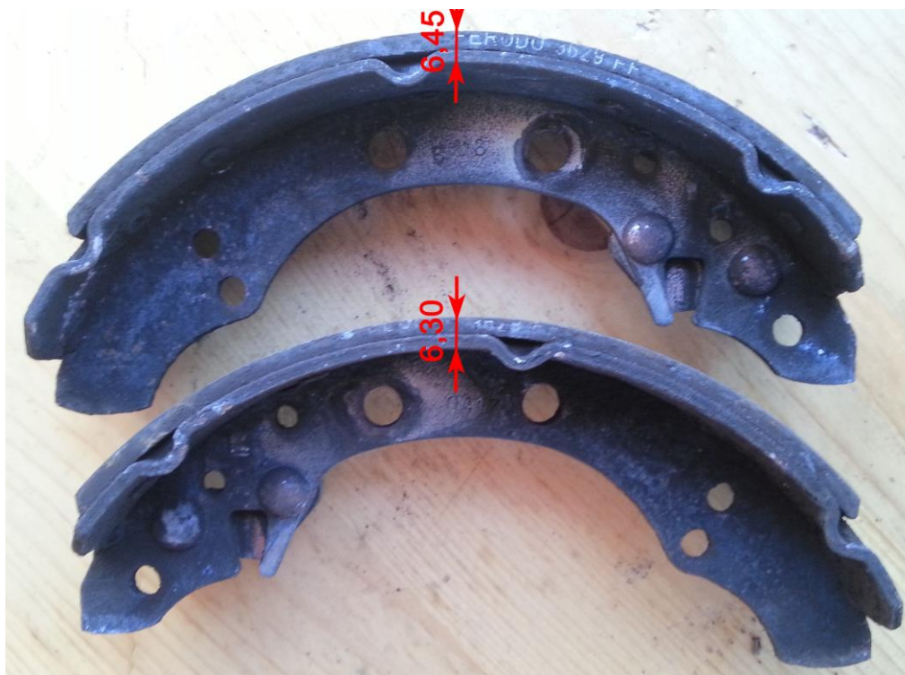
Slika 74. Debljina kočionih obloga bubanj kočnica
