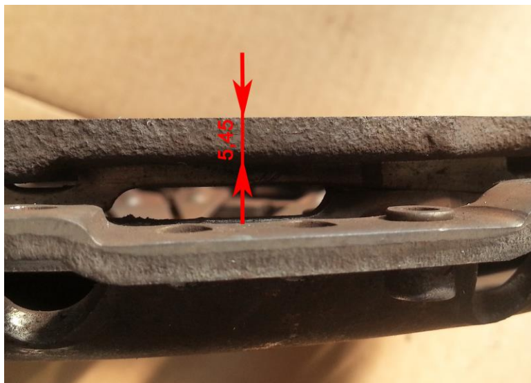
Slika 58. Izmjerena debljina potisne ploče
