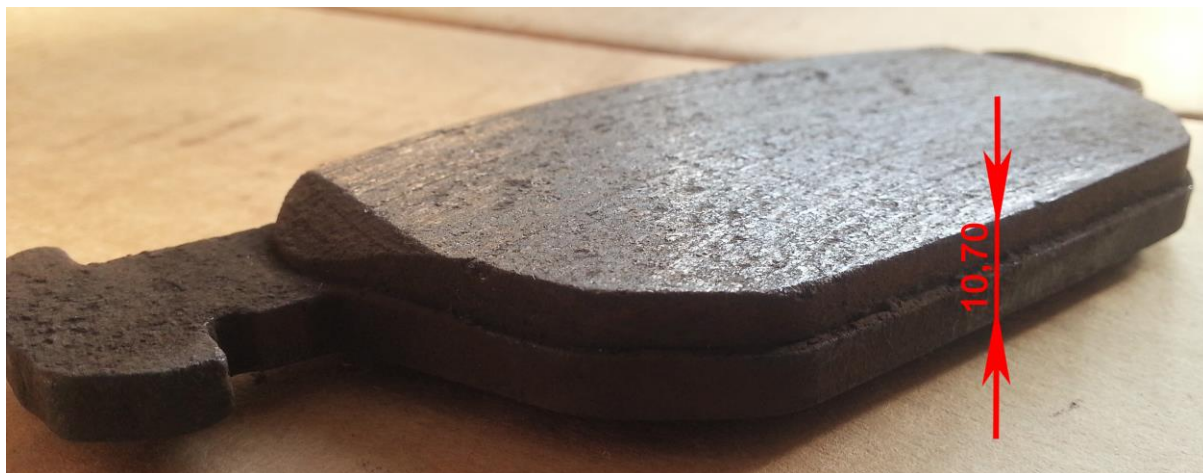
Slika 67. Debljina unutarnje strane vanjske kočione pločice 1
