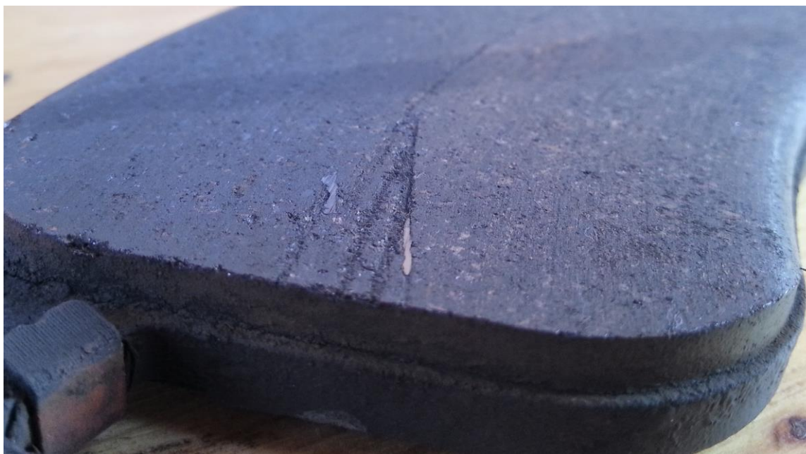
Slika 84. Trošena površina ispitivane kočione obloge
