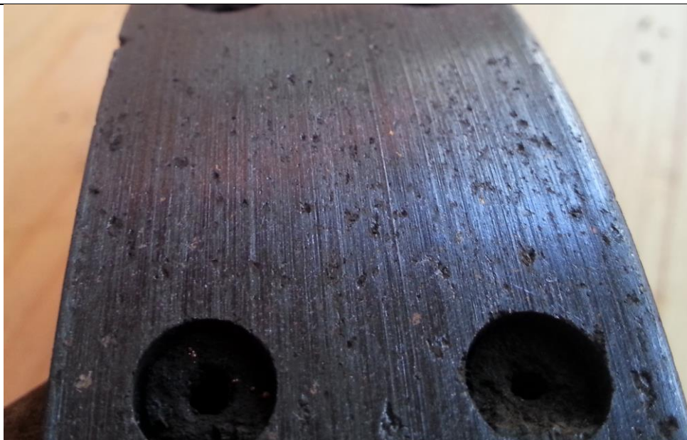
Slika 73. Površina potrošene kočione obloge bubanj kočnice
