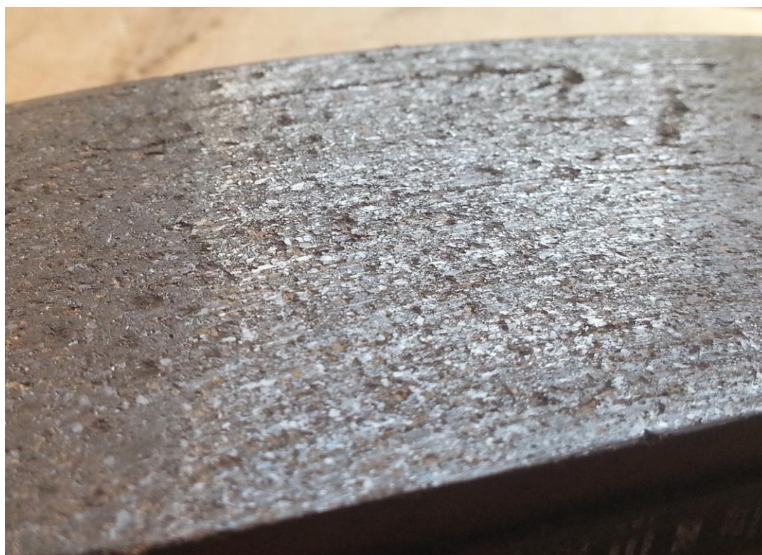
Slika 66. Trošena površina kočione pločice 1
