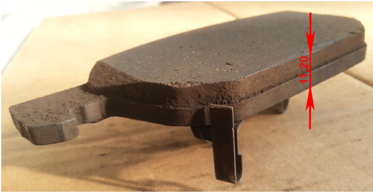
Slika 69. Debljina unutarnje strane unutarnje kočione pločice 1
