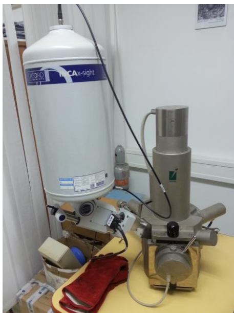
Slika 96. SEM s EDS-om
