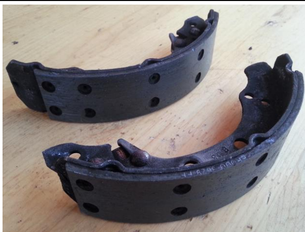
Slika 71. Potrošene obloge bubanj kočnice
