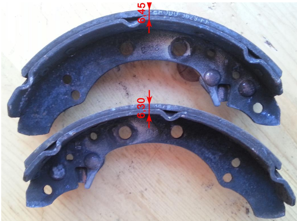
Slika 74. Debljina kočionih obloga bubanj kočnica
