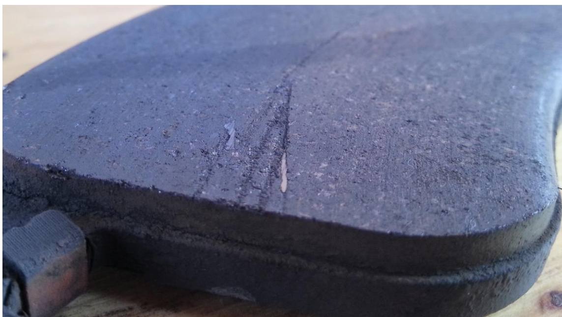
Slika 84. Trošena površina ispitivane kočione obloge
