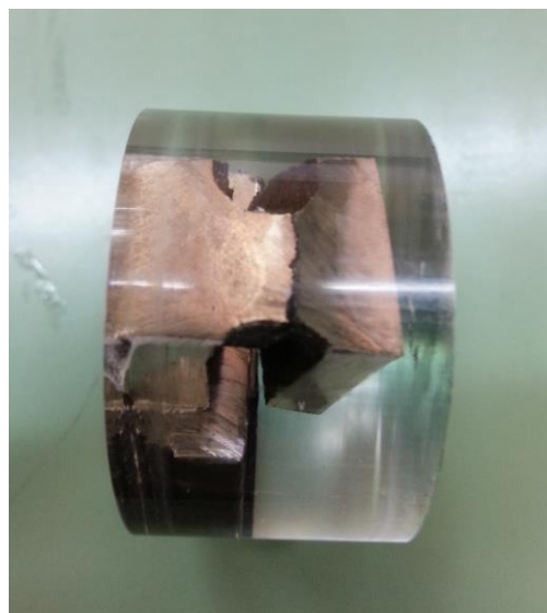
Slika 89. Napuknuće uzorka diska
