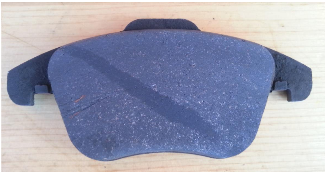
Slika 83. Ispitivana kočiona obloga
