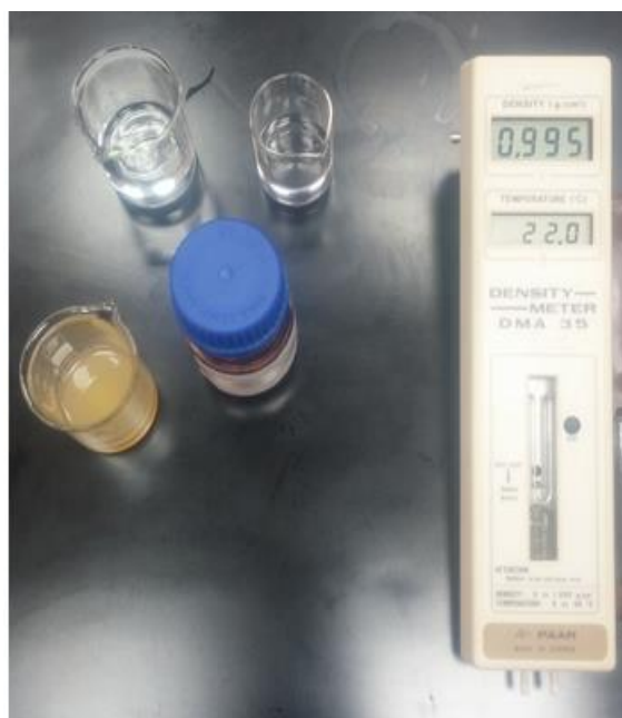
Slika 4.3. Uređaj za mjerenje gustoće ulja
