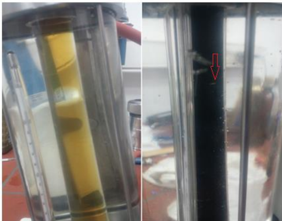
Slika 4.5. Kuglica u staklenoj cijevi viskozimetra
