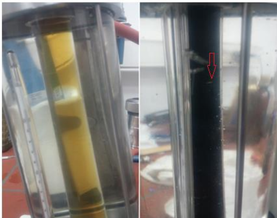
Slika 4.5. Kuglica u staklenoj cijevi viskozimetra
