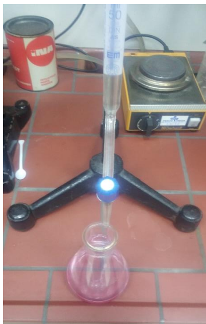
Slika 4.11. Nulta proba titracije etanola
