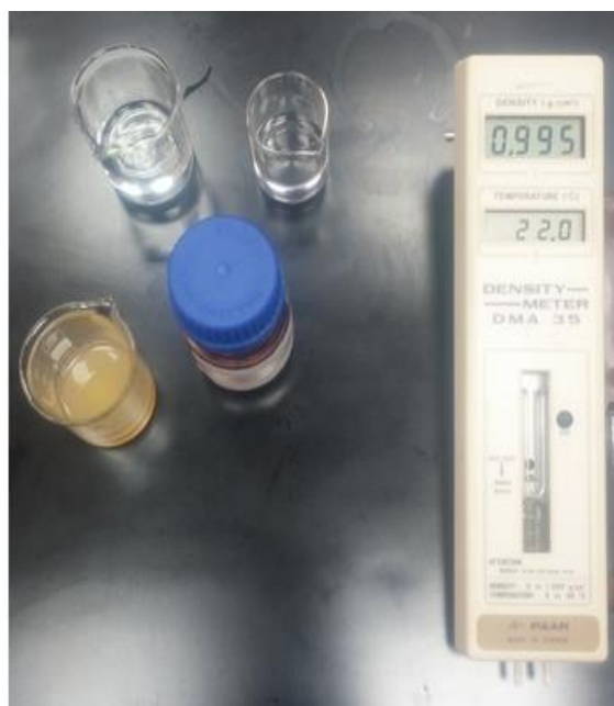
Slika 4.3. Uređaj za mjerenje gustoće ulja
