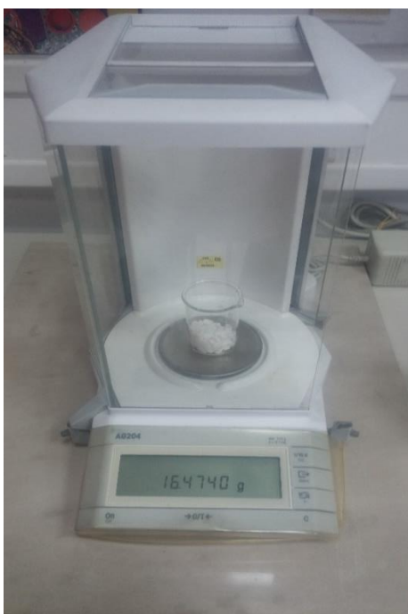
Slika 4.7. Mjerenje mase KOH pomoću analitičke vage
