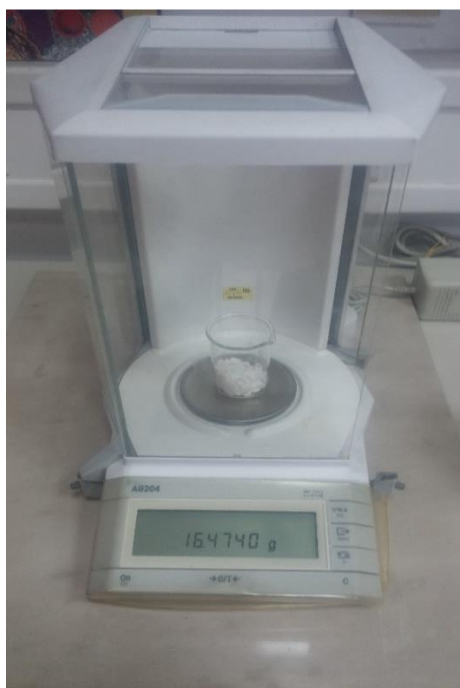
Slika 4.7. Mjerenje mase KOH pomoću analitičke vage
