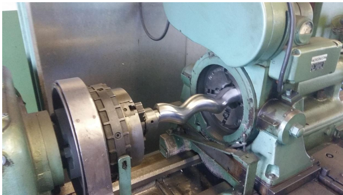
Slika 51. Završetak izrade spirale rotora vijčano-ekscentrične pumpe
