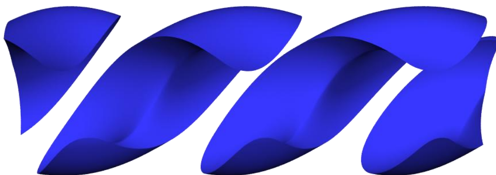
Slika 13. Prikaz šupljina unutar vijčano-ekscentrične pumpe [28]
