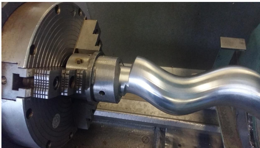
Slika 49. Kružna naprava s rotorom vijčano-ekscentrične pumpe stegnuta u amerikaneru
