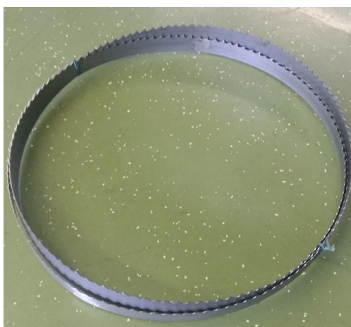
Slika 37. Rezna traka pile
