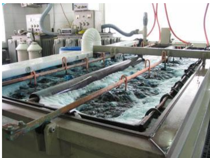
Slika 9. Prikaz procesa galvanizacije [20]
