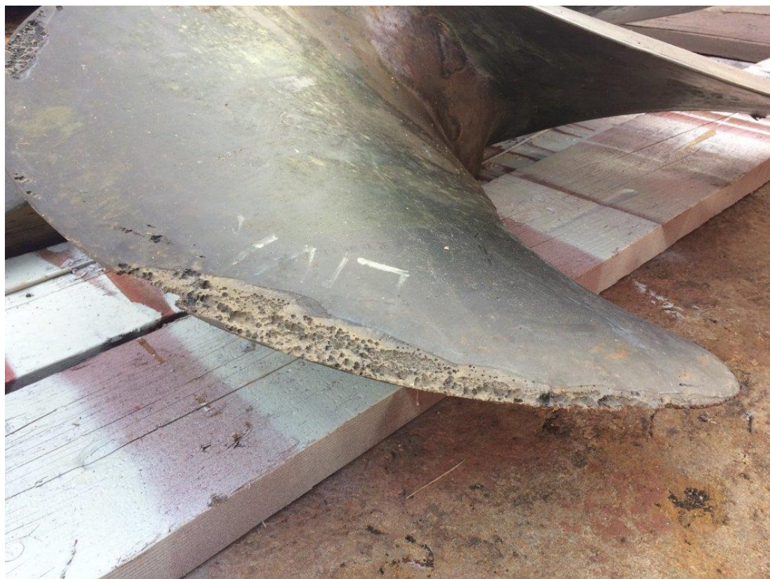
Slika 7. Kavitacija na brodskom propeleru [17]
