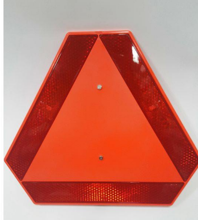
Slika 20. Sigurnosni reflektirajući trokut za spora vozila [13]
