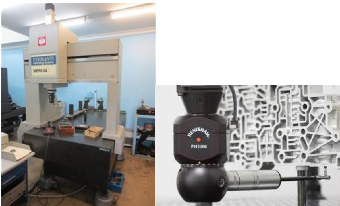
Slika 59. Trokoordinatni mjerni uređaj MERLIN I ticalo RENISHAW
