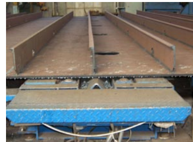
Slika 3.3.13 pomični magneti i trn
