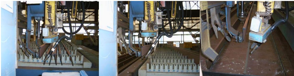
Slika 3.3.9 Dohvat i pozicioniranje profila
