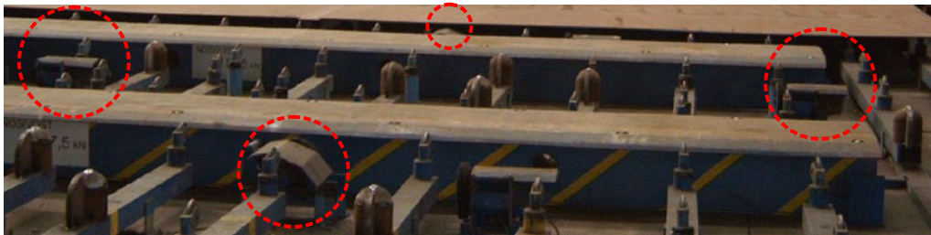
Slika 3.2.4 Naprava za rotiranje limova
