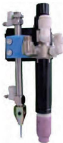
Slika 30. Mehanički kontaktni senzor (slika lijevo) i senzor za praćenje napona i struje električnog luka prilikom njihanja (slika desno) [17]
