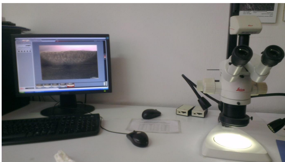
Slika 57. Snimanje makroizbrusaka korištenjem Leica MZ6 stereomikroskopa
