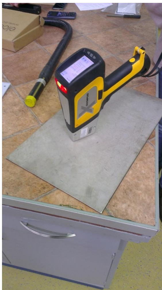
Slika 32. Ispitivanje kemijskog sastava ploče AISI 304
