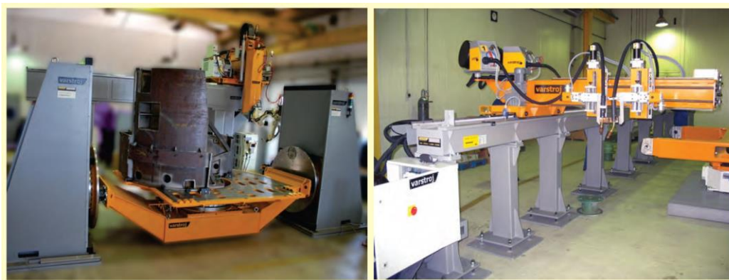
Slika 13. Primjer robotiziranog (lijevo) i automatiziranog (desno) zavarivanja [17]
