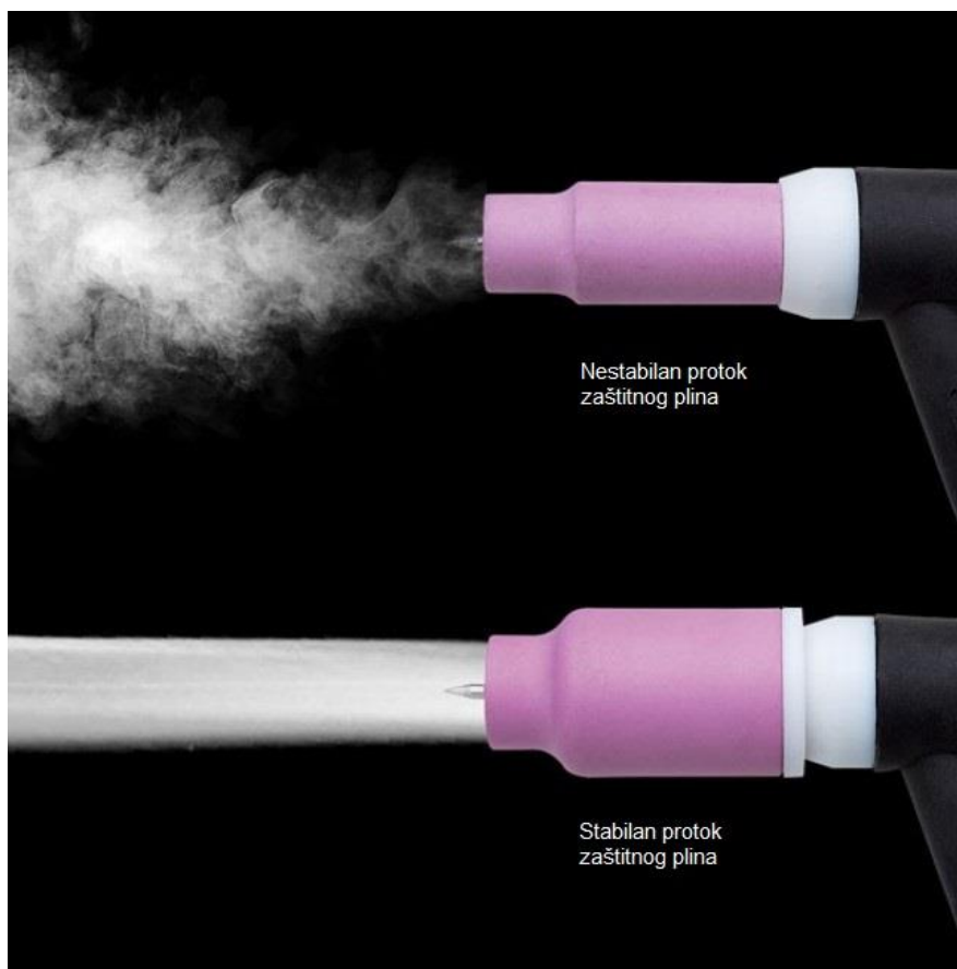
Slika 7. Stabilan i nestabilan protok zaštitnog plina [9]
