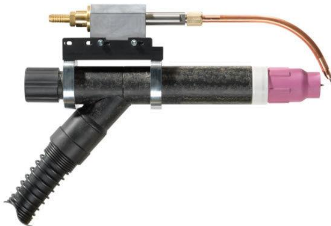
Slika 22. Pištolj za robotizirano TIG zavarivanje s automatskim dodavanjem dodatnog materijala 2 [19]
