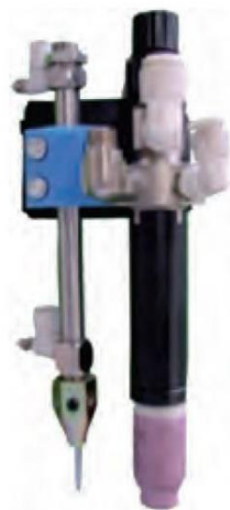
Slika 30. Mehanički kontakti sensor (slika lijevo) i senzor za praćenje napona i struje električnog luka prilikom njihavanja (slika desno) [17]
