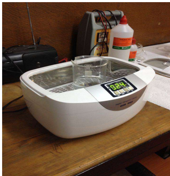
Slika 10. Ultrazvučni uređaj za čišćenje uzorka
