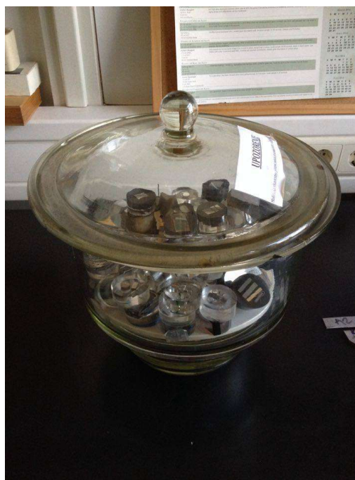
Slika 18. Eksikator sa silika-gel zrnima
