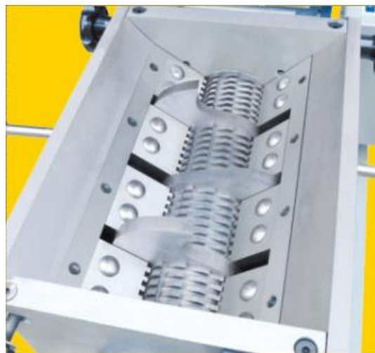
Slika 9. MTLS-250 - nož drobilice
