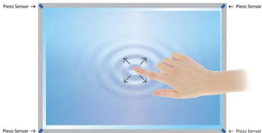
Slika 17. Zaslon koji koristi tehnologiju disperzivnih signala [14]
