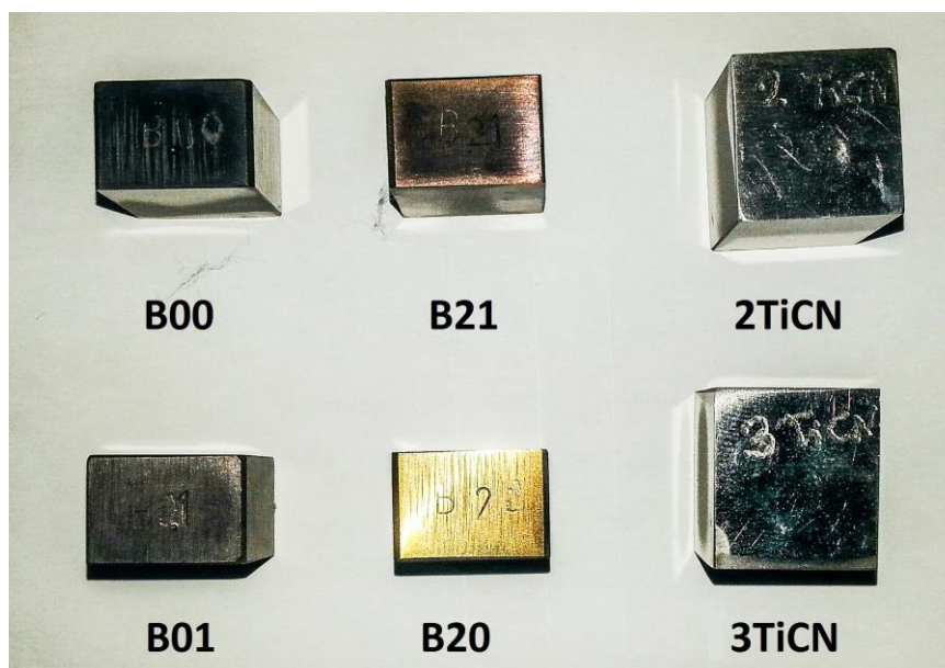
Slika 7.5. Ispitni uzorci za erozijsko trošenje
