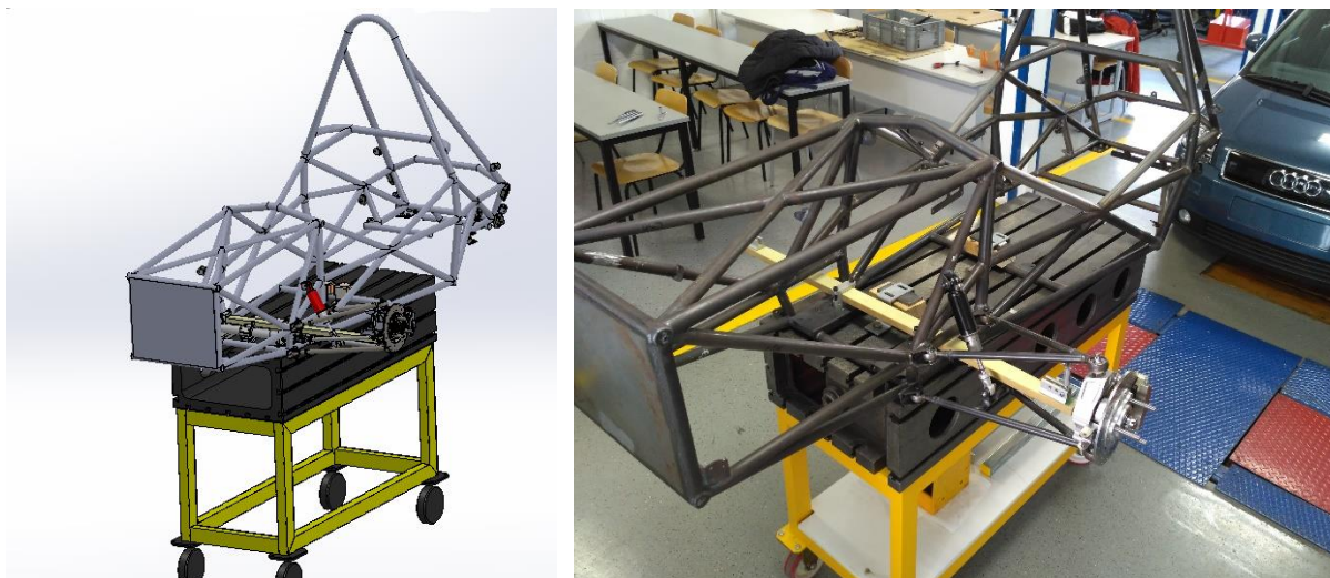
Slika 4.17. Prikaz spojene šasije i stolu u Solidworksu (lijevo) te u laboratoriju (desno).
