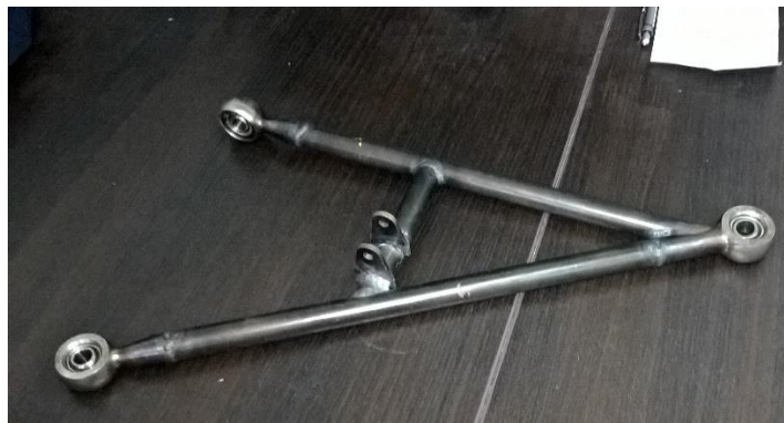
Slika 10. Donje stražnje rame bolida Strix
