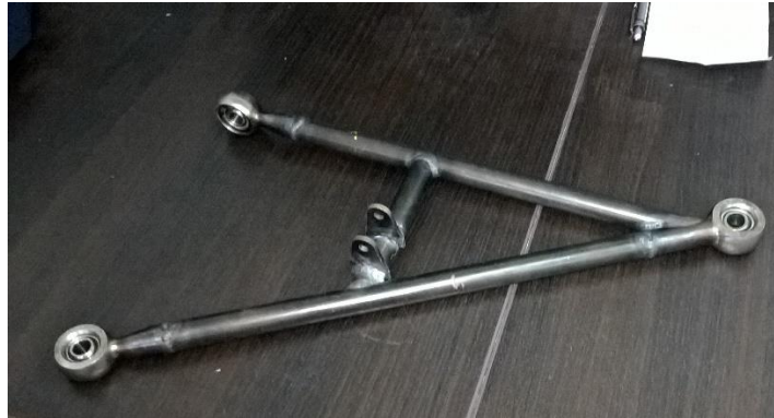
Slika 10. Donje stražnje rame bolida Strix
