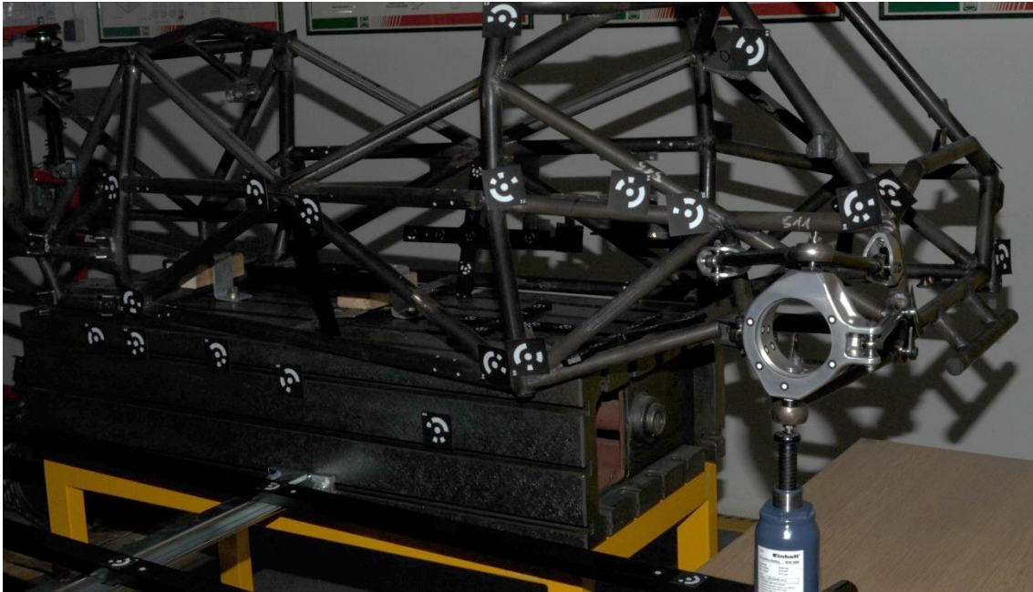
Slika 50. Šasija bolida pripremljena za mjerenje kinematičkih veličina kotača
