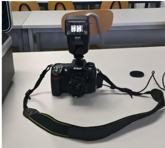
Slika 5. Digitalni fotoaparati TRITOP sustava
