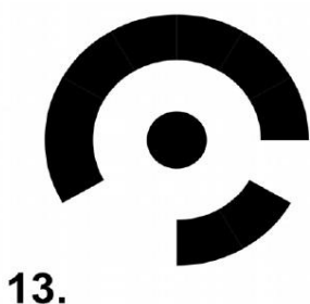
Slika 7. Kodirana referentna točka
