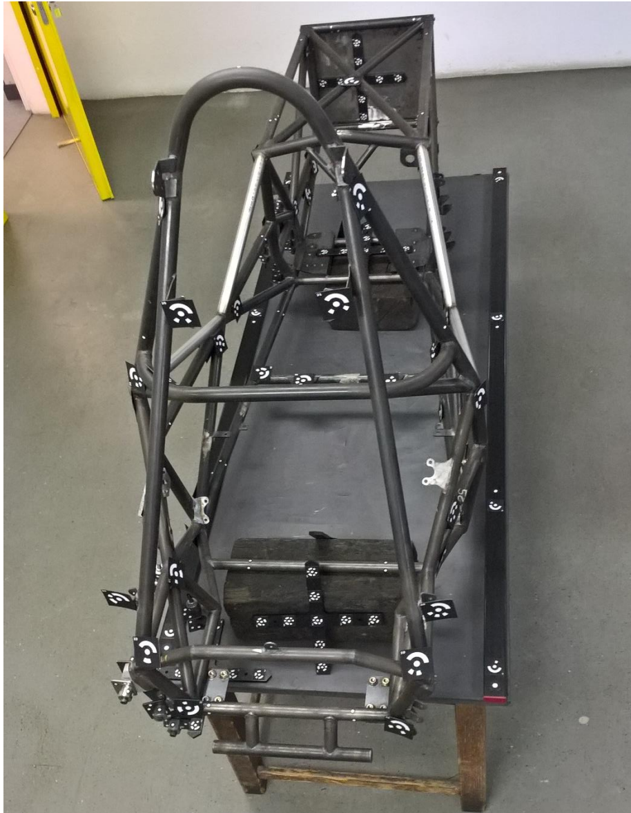
Slika 25. Šasija pripremljena za mjerenje
