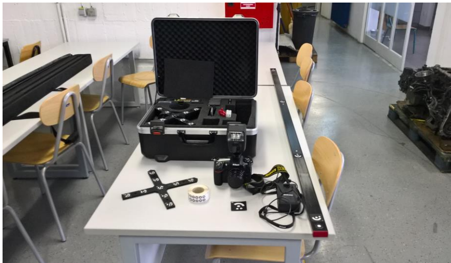
Slika 4. Mjerna oprema TRITOP
