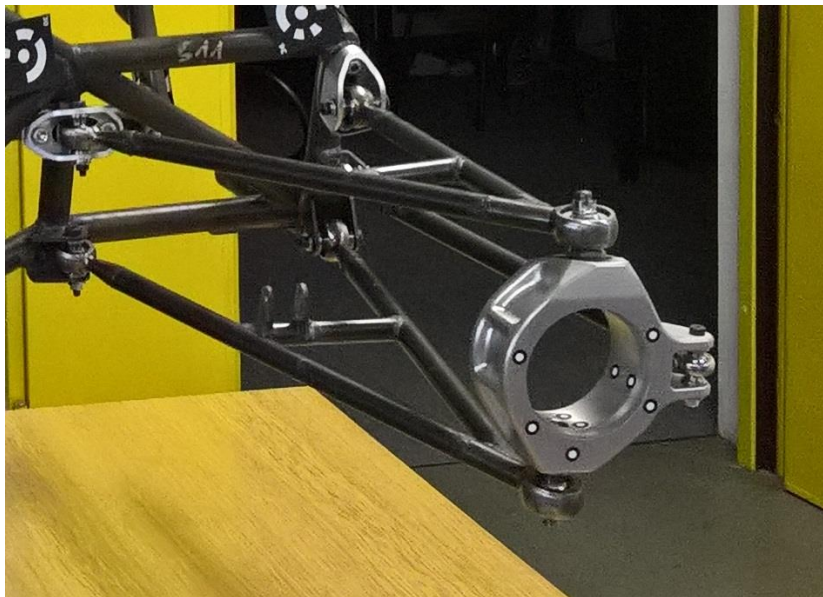
Slika 49. Upright pripremljen za mjerenje
