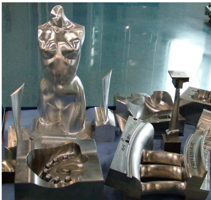
Slika 10. Primjeri proizvoda dobivenih glodanjem [7]
