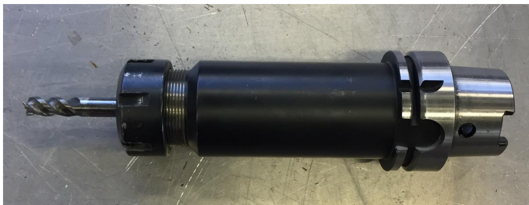
Slika 44. Ravno glodalo \Phi 10 u držaču alata HSK 63
