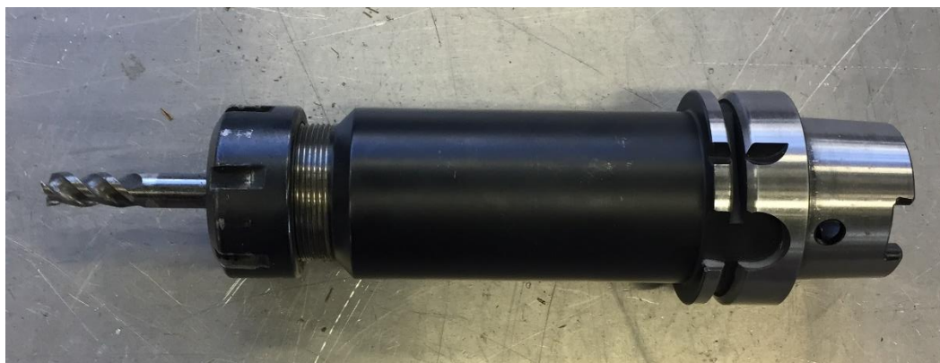
Slika 44. Ravno glodalo \Phi 10 u držaču alata HSK 63
