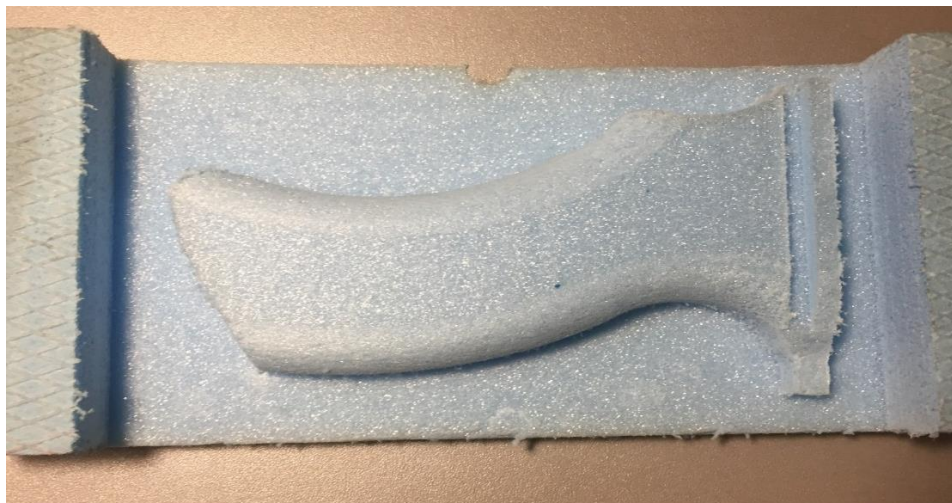
Slika 46. Izgled drške ručne bušilice nakon izrade na glodalici
