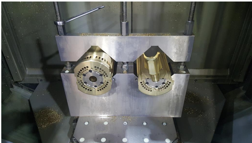
Slika 24. Prikaz stezanja kalupa na postolje
