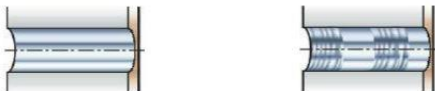
Slika 10. Provrt s dobrim odvođenjem odvojenih čestica (lijevo) i provrt s lošim odvođenjem odvojenih čestica (desno) [9]
