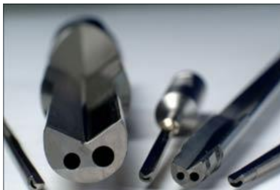
Slika 18. Jednorezna topovska svrdla poduzeća TIEFBOHRTECHNIK [6]
