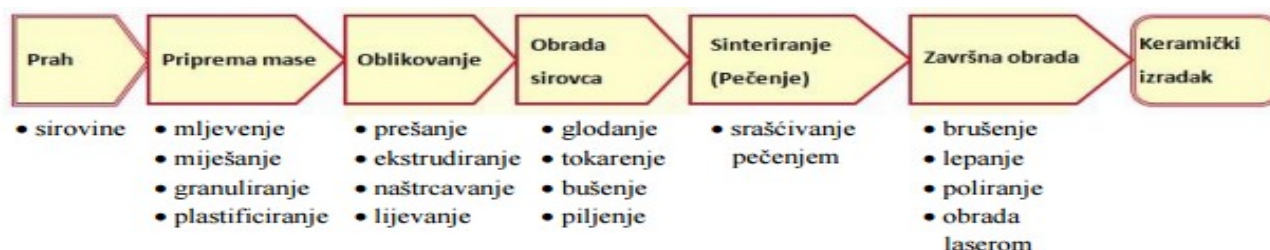
Slika 4. Koraci pri proizvodnji tehničke keramike [7]
