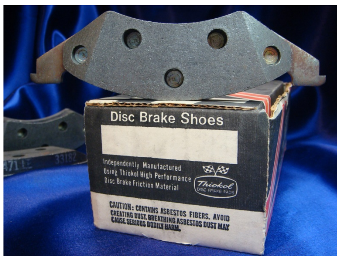
Slika 15. Kočne pločice s azbestnim vlaknima [16]
