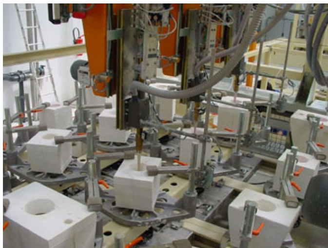
Slika 11. Izgled linije automatiziranog postupka lijevanja suspenzije [11]
