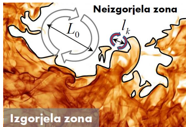
Slika 10. Izgorjela i neizgorjela zona u cilindru [4]
