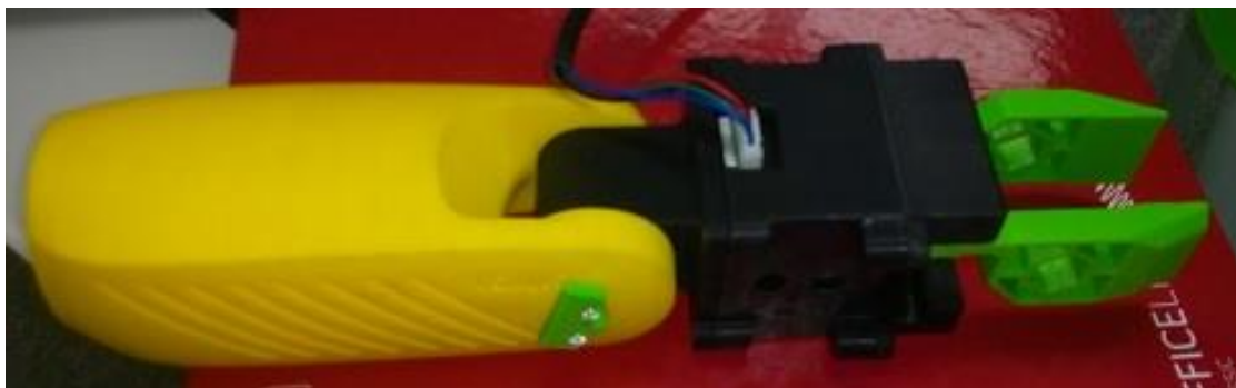
Slika 33. Prihvatnica spojena na članak robotskog manipulatora
