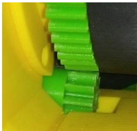
Slika 6. Zupčanik koračnog motora u zahvatu sa zupčanikom članka robotskog manipulatora
