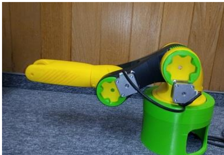
Slika 4. Robotski manipulator izrađen na 3D printeru za kojeg se izrađuje prihvatnica
