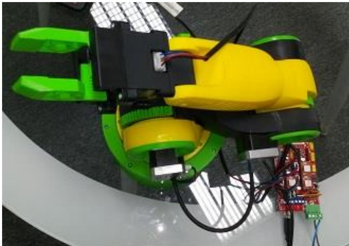
**Slika 35. Robotski manipulator sa prihvatinicom**
