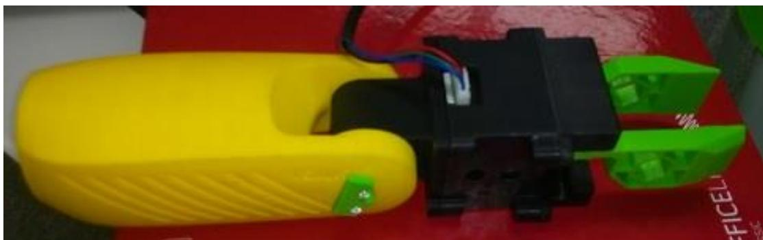
Slika 33. Prihvavnica spojena na članak robotskog manipulatora
