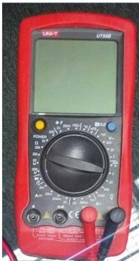
Slika 17. Multimetar kojim se mjeri napon
