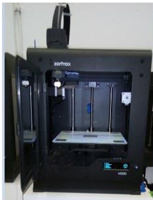
Slika 10. 3D printer Zortrax M200
