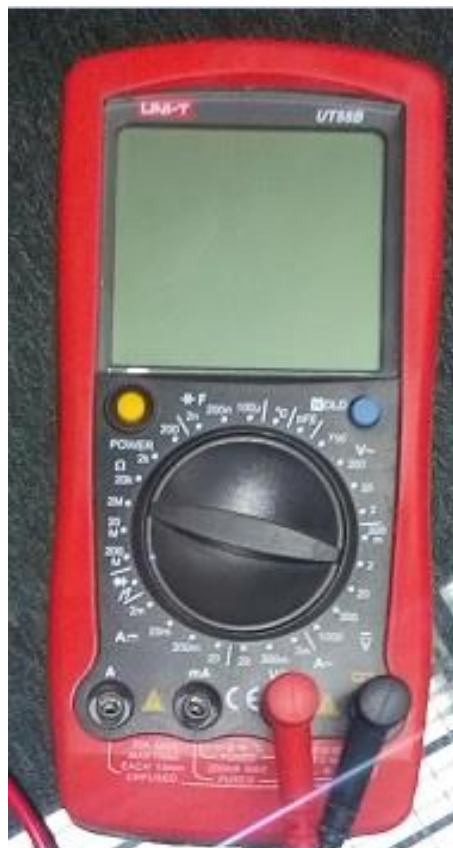
Slika 17. Multimeter kojim se mjeri napon
