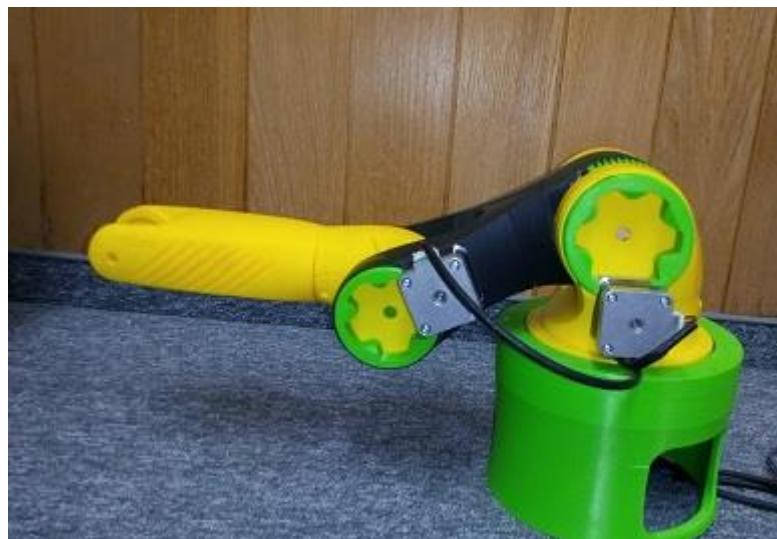
Slika 4. Robotski manipulator izrađen na 3D printeru za kojeg se izrađuje prihvavnica
