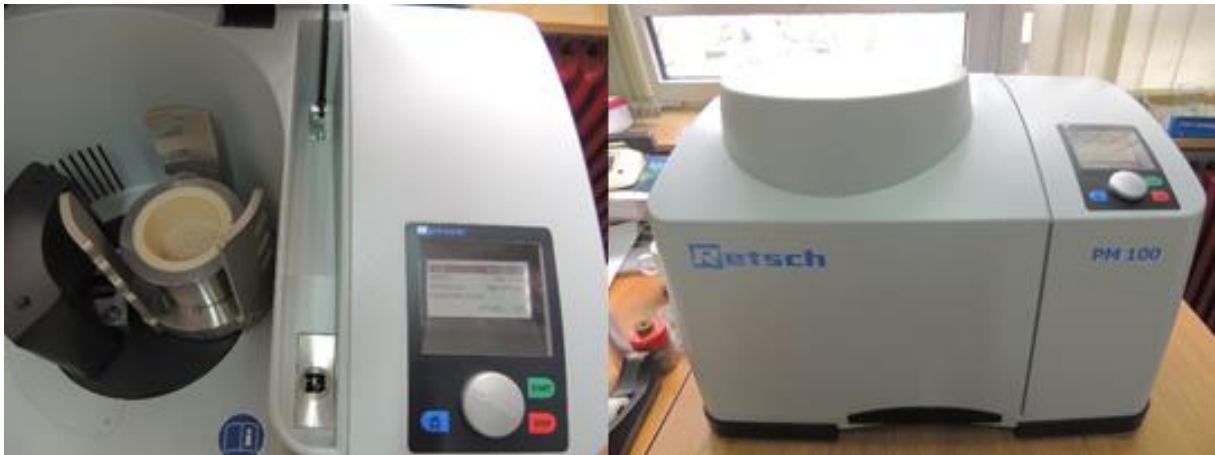
Slika 9. Usitnjavanje ljusaka jajeta u planetarnom kugličnom mlinu
