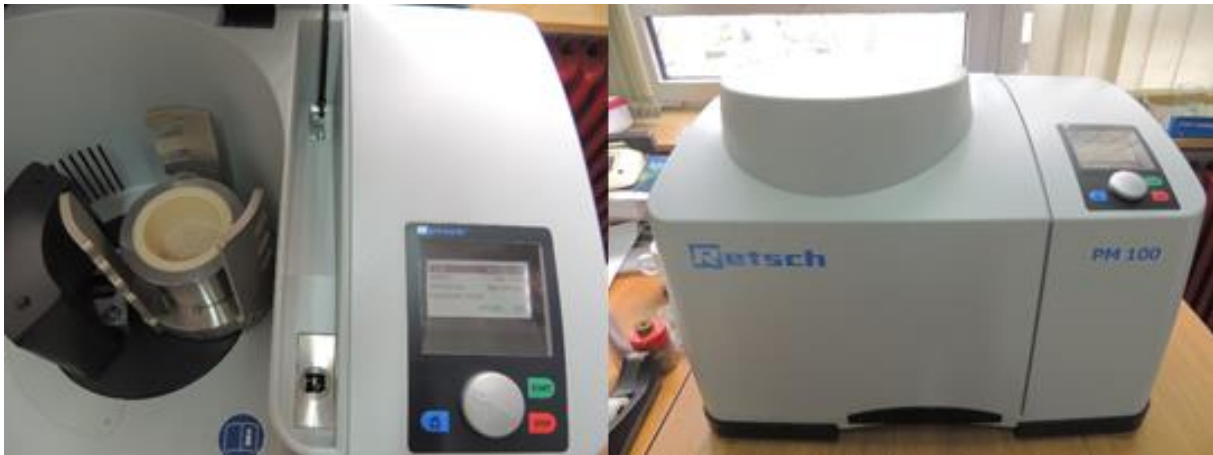
Slika 9. Usitnjavanje ljusaka jajeta u planetarnom kugličnom mlinu
