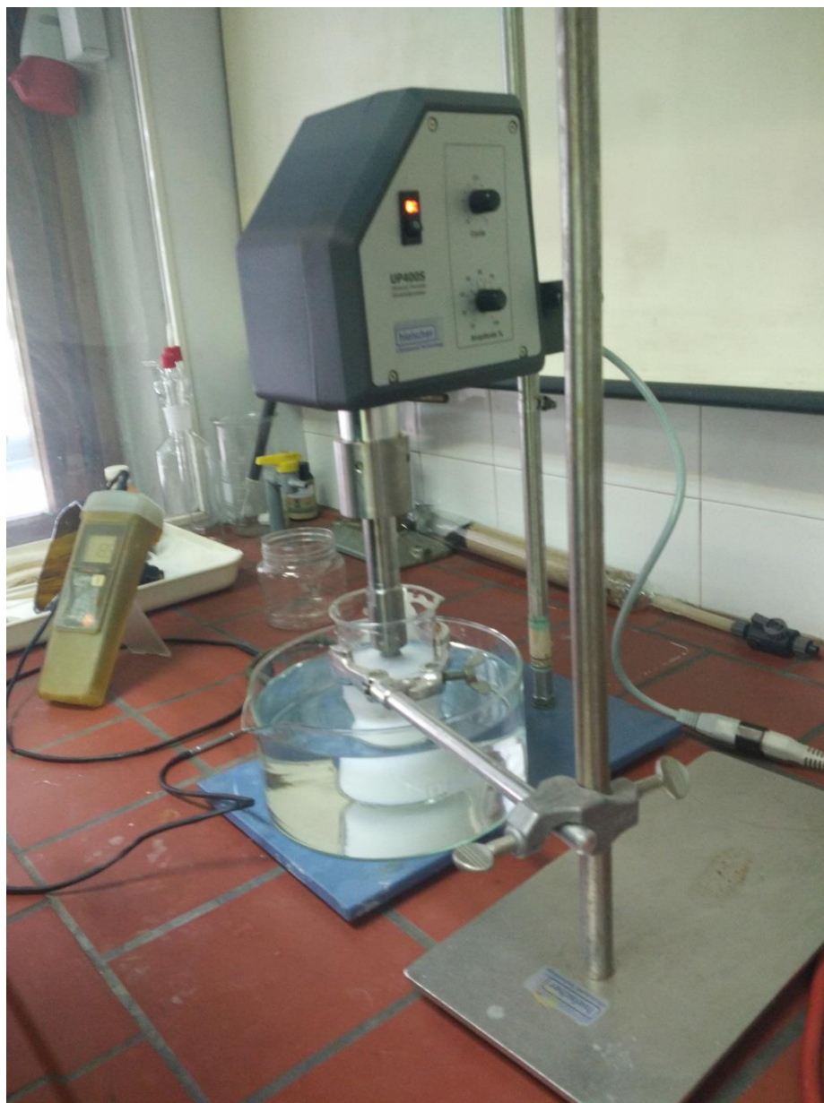
Slika 13. Tretiranje smjese kalcijevog hidroksida i fosfatne kiseline ultrazvučnom sondom Hielscher UP400S
