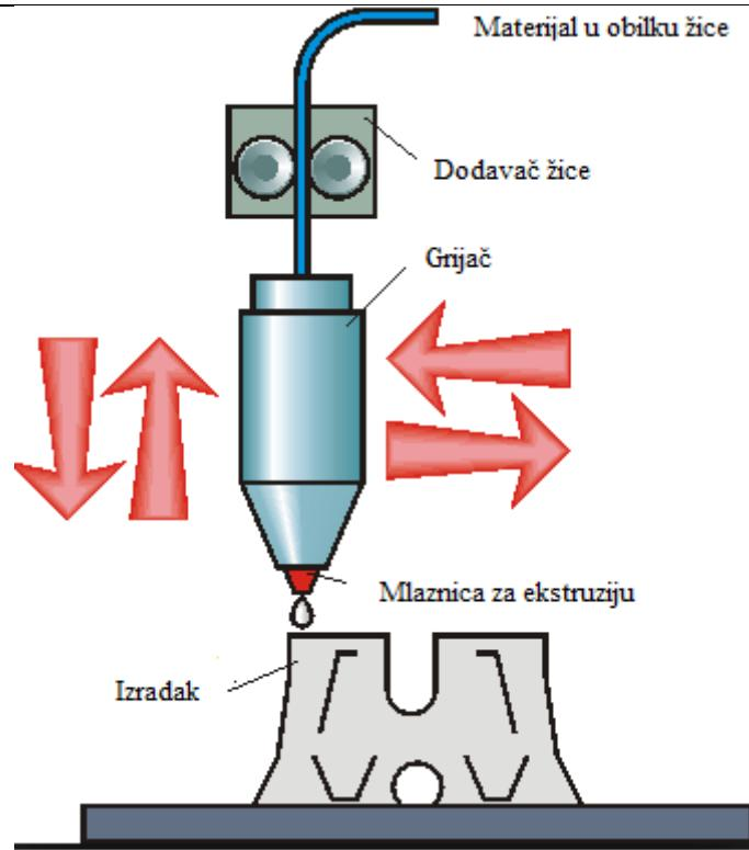
Slika 8. Princip rada ekstruzijskog slaganja[16]
