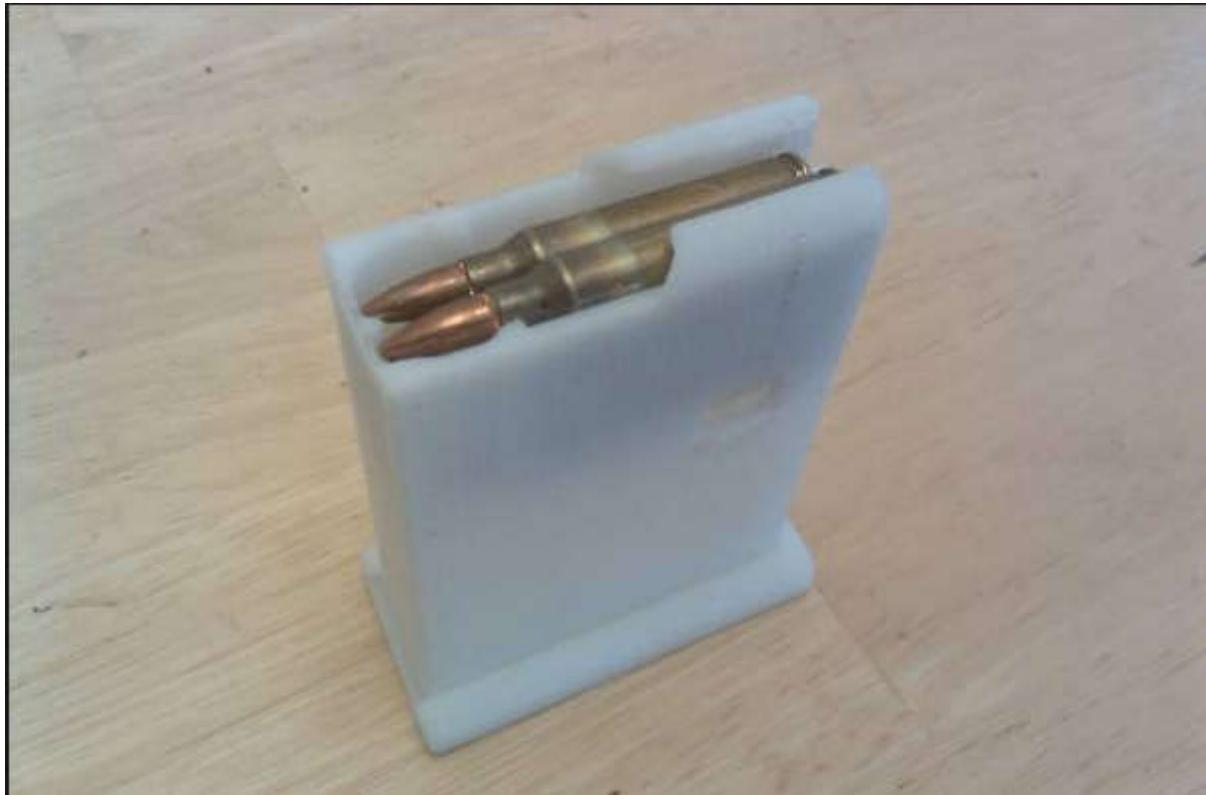
Slika 13. Okvir za metke izrađen 3D printanjem[21]
