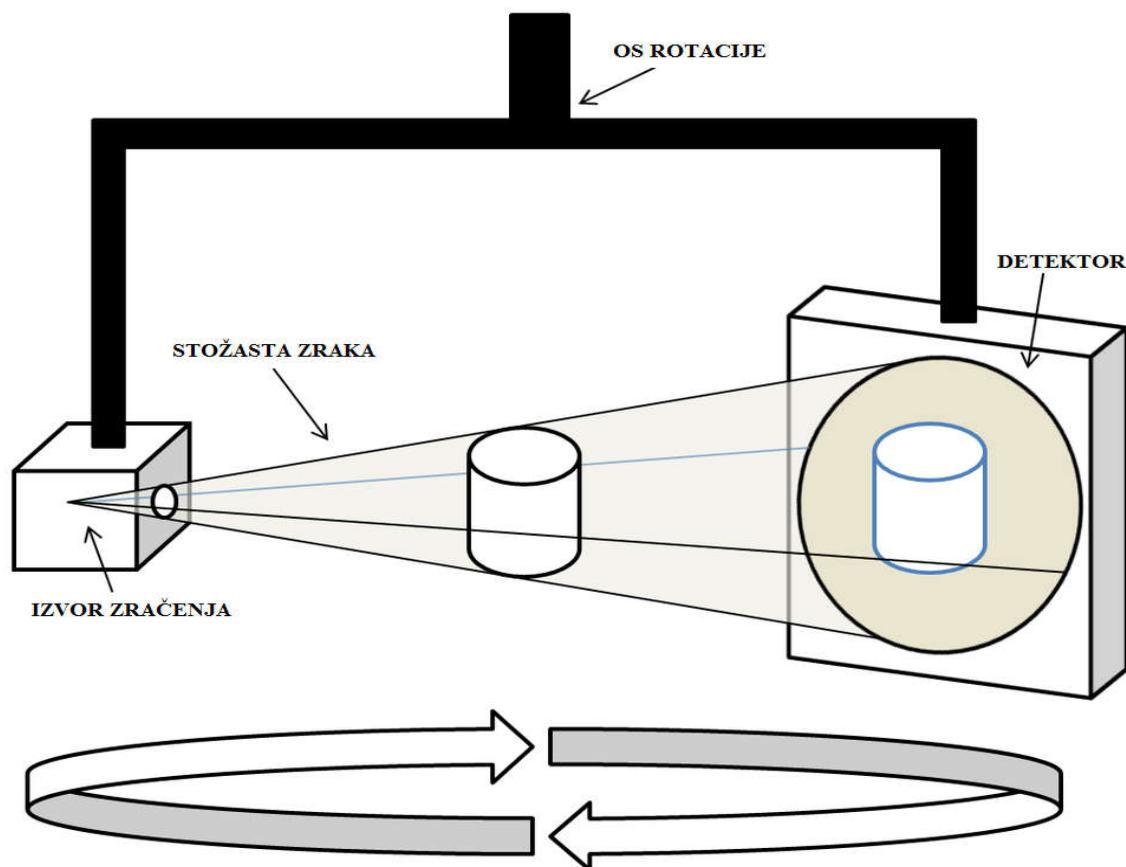
Slika 23. Princip rada CBCT uređaja[24]
