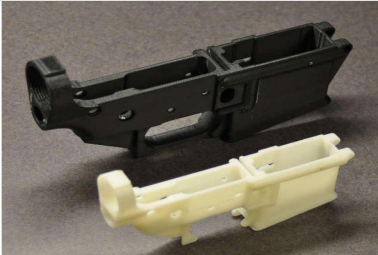
Slika 14. Konstrukcijski dijelovi oružja izrađeni 3D printanjem[22]
