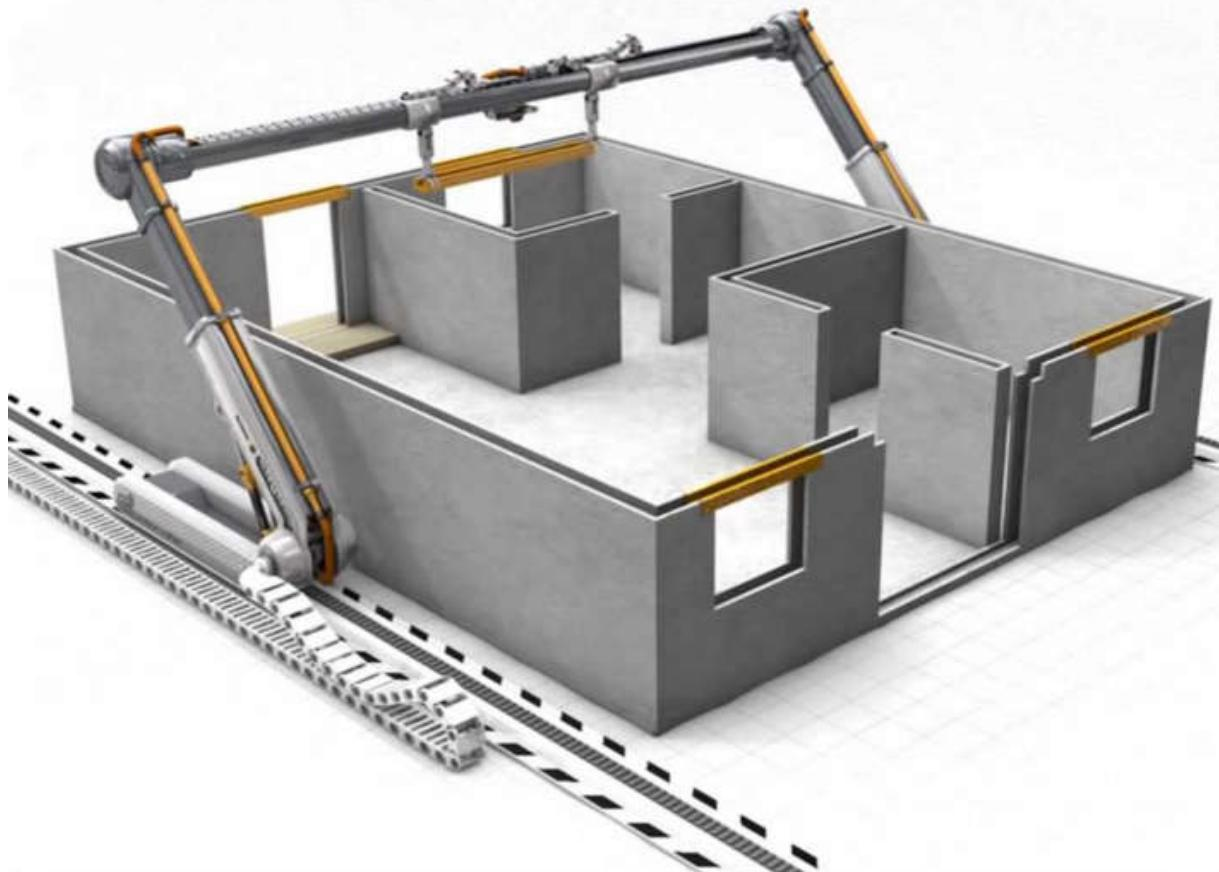
Slika 12. Koncept 3D printerja za primjenu u građevinskoj industriji[20]
