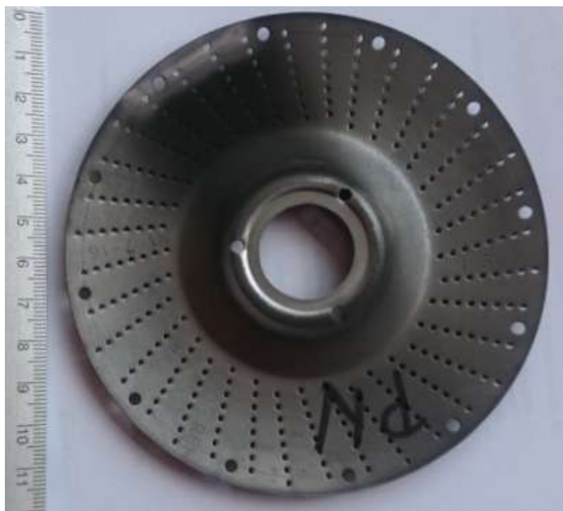
Slika 19. Izgled ispitnog uzorka nakon postupka plazmatskog nitiranja (uzorak 2)
