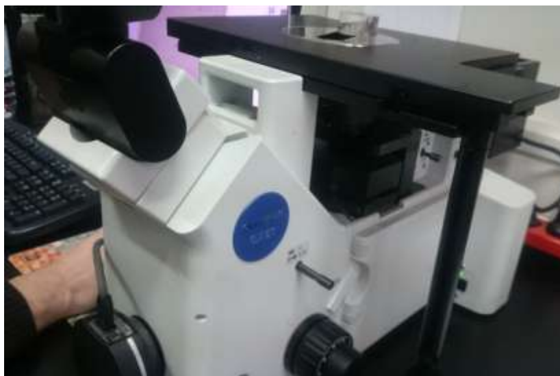
Slika 33. Svjetlosni mikroskop GX51
