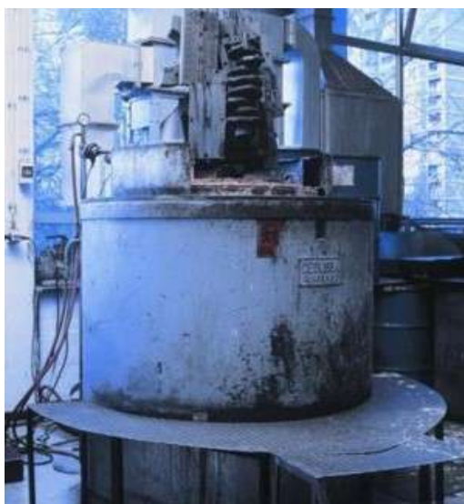
Slika 14. Peć za postupak tenifer "DURFERRIT-DEGUSSA GmbH"
