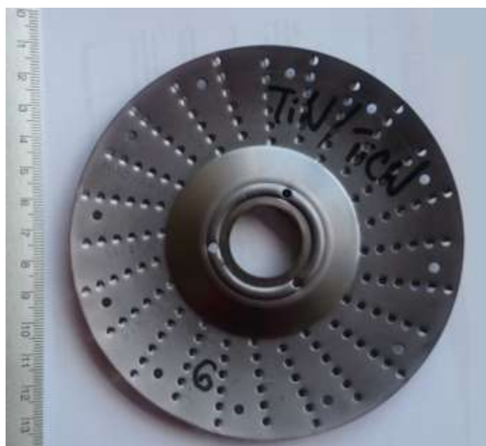
Slika 21. Izgled ispitnog uzorka nakon postupka plazmatskog nitriranja i prevlačenja TiN/TiCN (uzorak 4)
