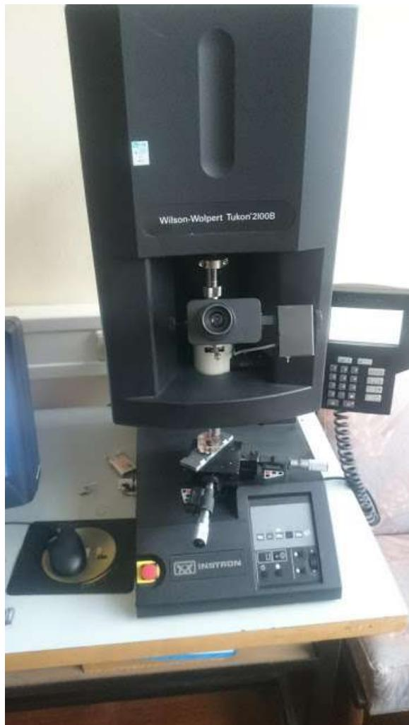
Slika 27. Mikrotvrdomjer *Instron Wilson Wolpert Tukon 2100b*
