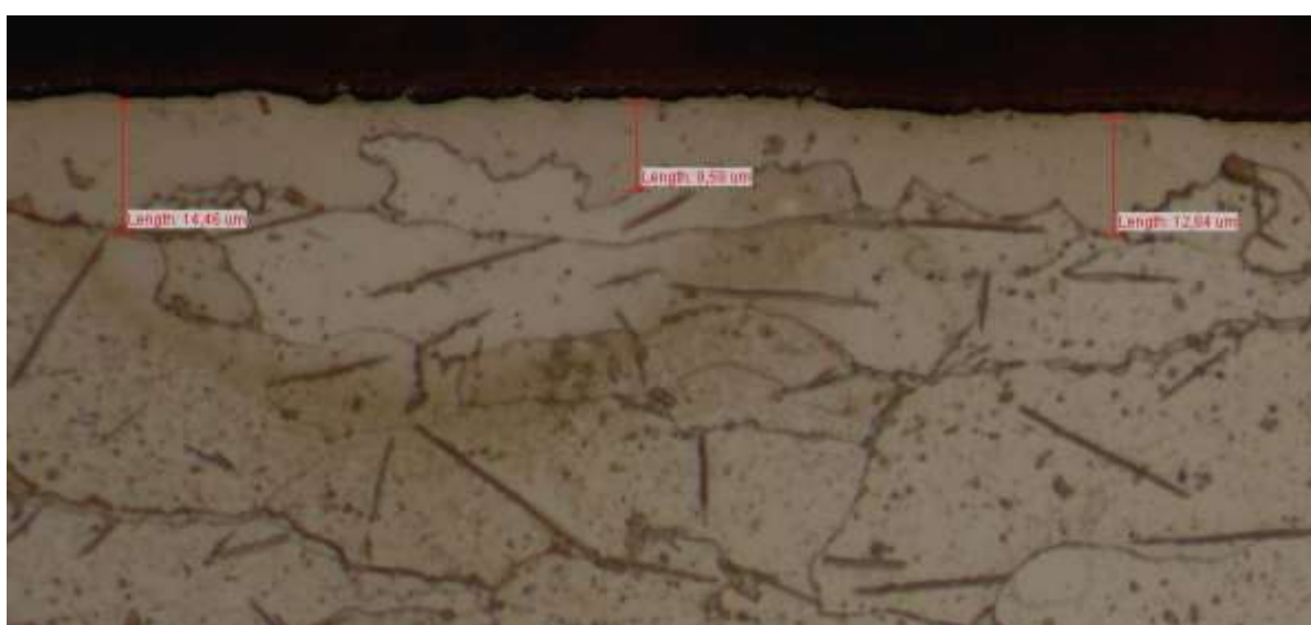
Slika 38. Zona spojeva, uzorak 2 pozicija 5, povećanje 500x
