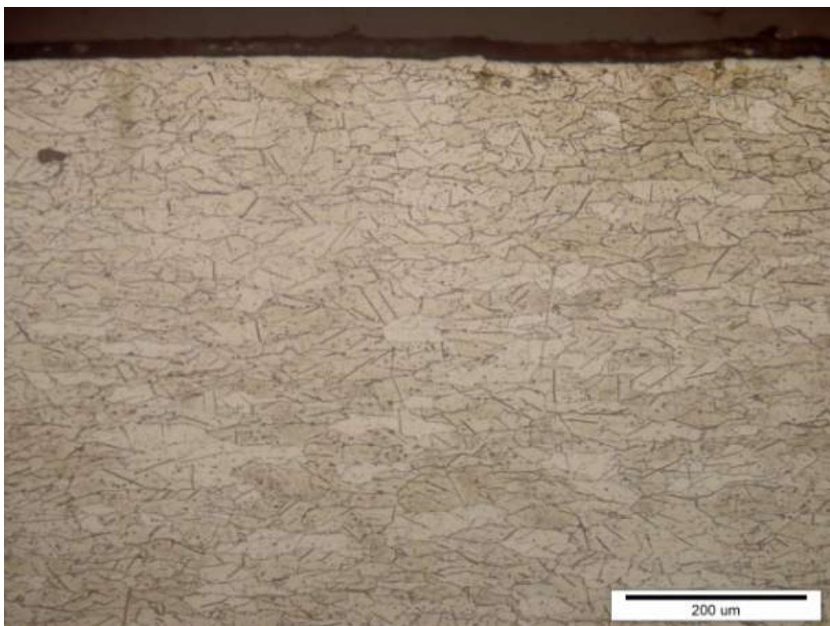
Slika 37. Uzorak 2 obrađen u plazmatskim nitriranjem pozicija 5, povećanje 200x
