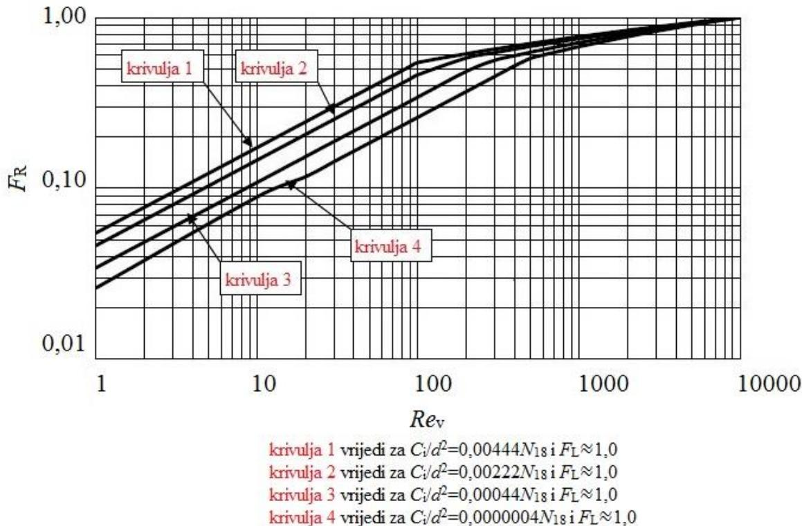
**Slika 9.** Očitanje faktora Reynoldsovog broja za ventil sa zapornim elementom s izrezom [1]
