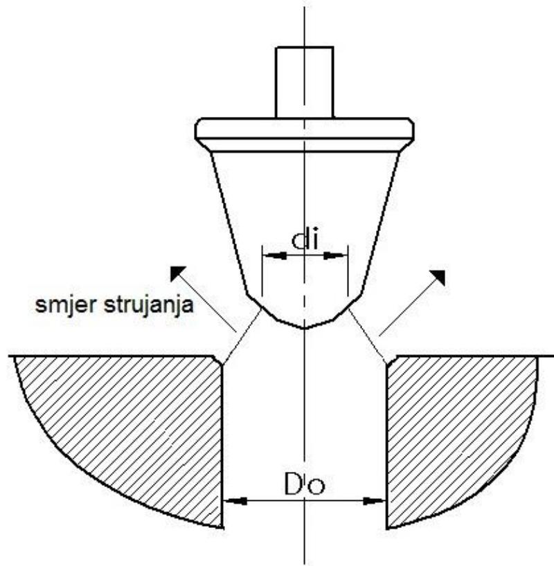
**Slika 12. Primjer ventila s konturnim pladnjem**
