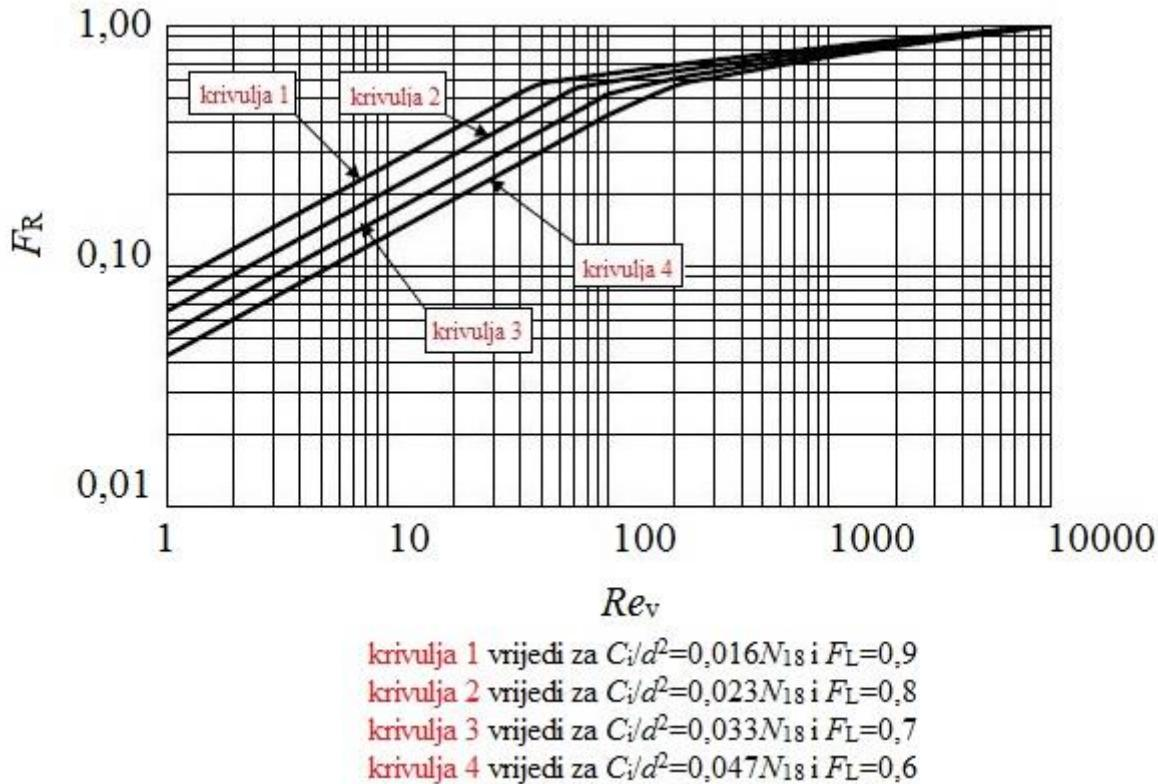
**Slika 8. Očitanje faktora Reynoldsovog broja za ventila sa zapornim elementom bez izreza [1]**
